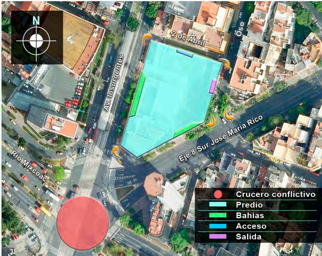
Imagen 8.5.A. Vista satelital del predio con diagrama gráfico de soluciones al congestionamiento vial. Fuente: Propia del Autor.
