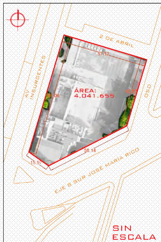
Imagen 3.2.A. El perímetro en color rojo representa la superficie de los tres predios unidos, formando un polígono irregular con cinco fachadas hacia las avenidas circundantes. Fuente: Propia del Autor
