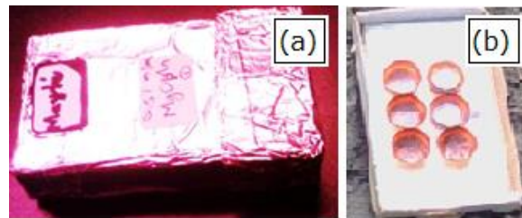
Figura 3.5 (a) Portamuestra de caja de 5x3 cm cerrada donde se almacenaron las muestras, (b) Compartimientos donde se colocaron los discos con las pastillas al interior de las cajas.
