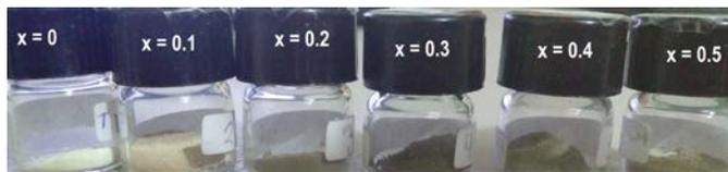
**Figura 7.** Fotografía que muestra el producto obtenido en el proceso de síntesis de las nanopartículas de  $\text{In}_{2-x}\text{Ni}_x\text{O}_3$  ( $x = 0, 0.1, 0.2, 0.3, 0.4$  y  $0.5$ ) obtenidas con KOH.
