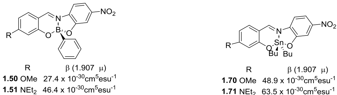
Figura 1.21. Datos experimentales EFISH ( \beta en \text{cm}^5 \text{esu}^{-1} ) para los compuestos 1.50 y 1.51, 1.70, 1.71 , tomados a 1.907 \mu\text{m} .
