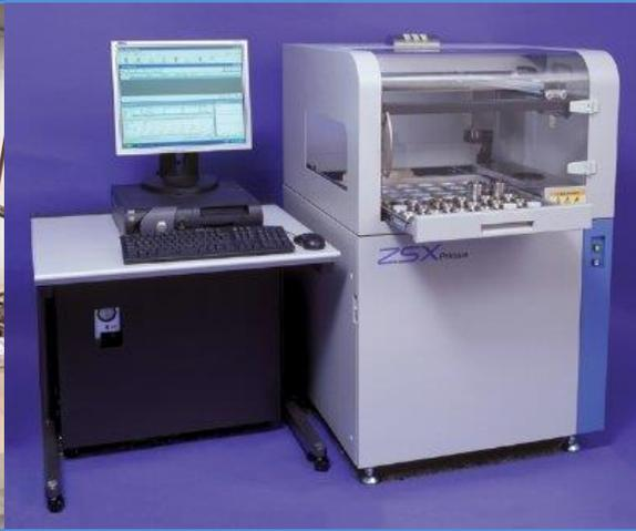
**Figura 132.** Espectrómetro secuencial de Fluorescencia de rayos X Rigaku ZSX Primus II.
