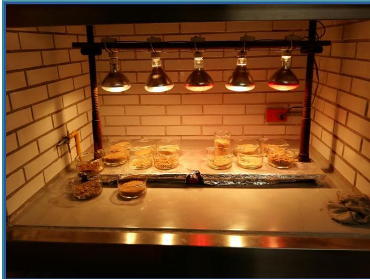
**Figura 10.** Secado de muestras en laboratorio. Tomada en el Laboratorio de sedimentología de ICMYL.
