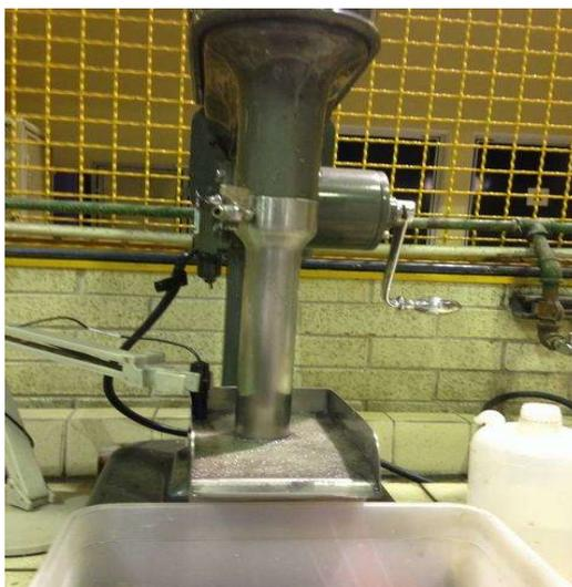
*Figura 3.9 Celda de flotación Denver.*
