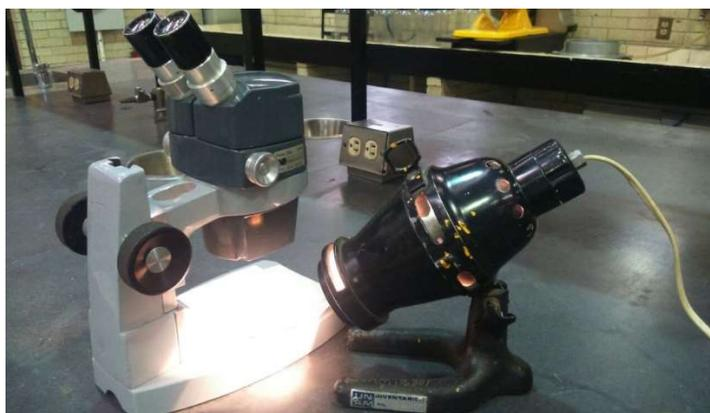
*Figura 3.7 Microscopio Estereoscópico American Óptica AO 570.*
