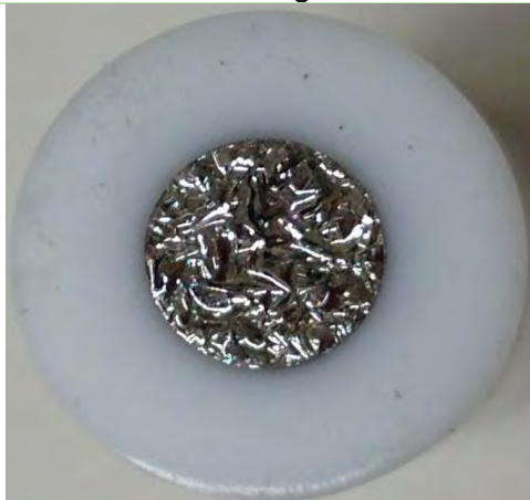
C) Fotografía de recubrimiento obtenido con 0.1 mL/L Ultralight MTTO
