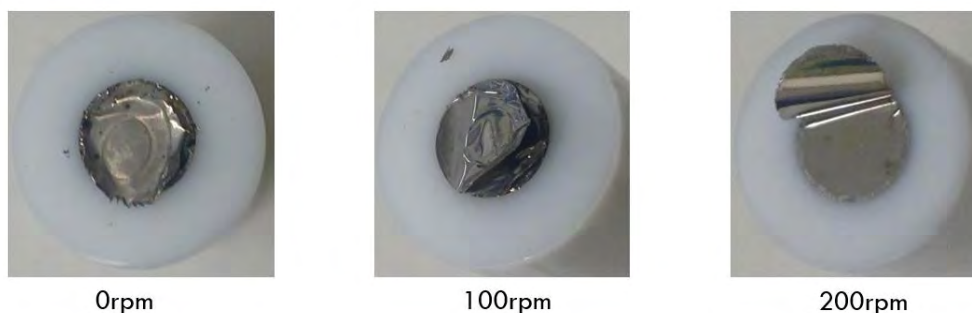
Figura 28 Fotografías de las puntas después de la prueba CP para níquel, 15 minutos a i = -200 \mu\text{A}/\text{mm}^2
