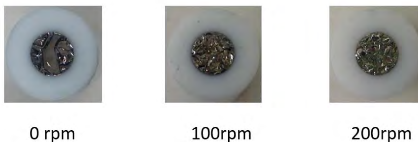
Figura 34 Fotografías de las puntas después de la prueba CP para níquel-cobalto-boro, 15 minutos a i = -200 \mu\text{A}/\text{mm}^2
