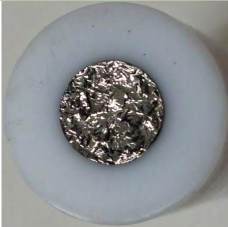
B) Fotografía de recubrimiento obtenido con 0.05 mL/L Ultralight MTTO
