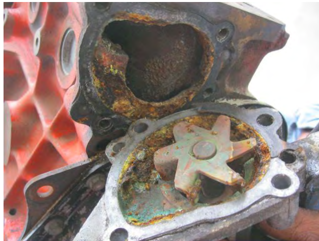
Figura 3 Pieza con corrosión a alta temperatura
