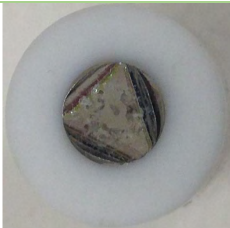
A) Fotografía de recubrimiento obtenido con 0.625 mL/L Ultralight Carrier
