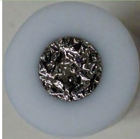
A) Fotografía de recubrimiento obtenido con 0.025 mL/L Ultralight MTTO
