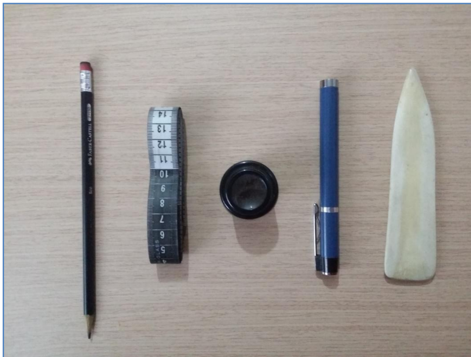
Figura 52. Herramientas utilizadas para el registro de información (de izquierda a derecha): lápiz, flexómetro, monóculo, lámpara médica y plegadera de hueso
