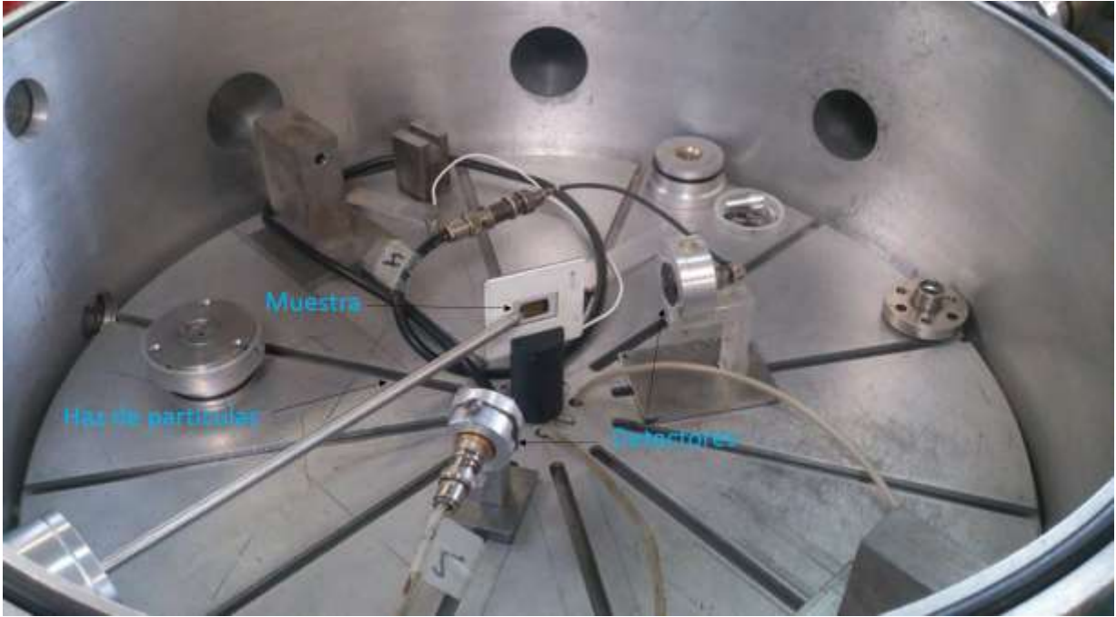
Figura 2.2.- Arreglo experimental que se utilizó en la cámara para las medidas de ERDA en el acelerador Van de Graff 5.5 MeV.
