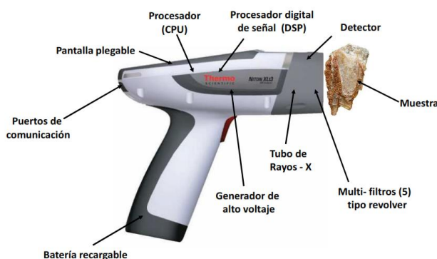
Figura 8. Esquema que muestra las partes principales del equipo Thermo Scientific Niton XL3t GOLDD 900 Analyzer (Tomado de Manual de características del analizador portátil de FRX Niton, 2011).
