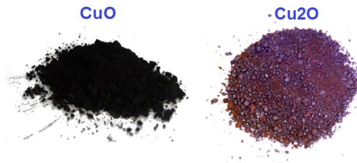
Fig. 5.12. La figura muestra la comparativa visual del reactivo inicial CuO y el producto final Cu_2O .
