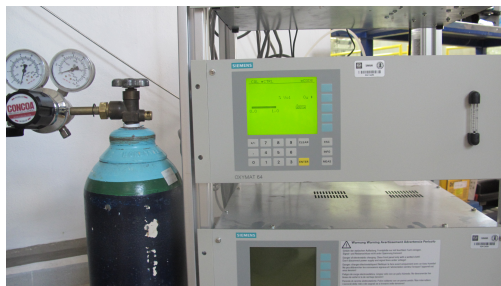
Fig. 2.10. Calibración del MM1 (1%) del analizador de gases Oxymat 64.
