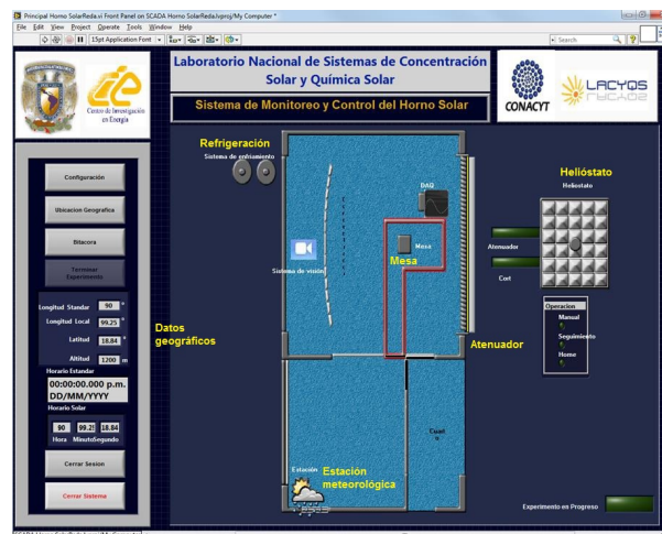
Fig. 2.2. Pantalla principal del sistema de control del HoSIER.
