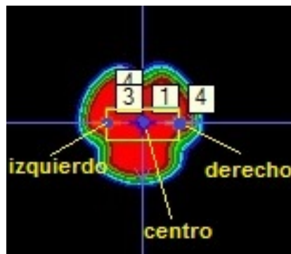
Fig. 3.10. Imagen termográfica con el eje de coordenadas definido para el análisis.
