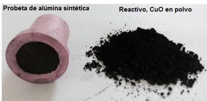
Fig. 5.1. Probeta de alúmina con CuO y el reactivo CuO en polvo.
