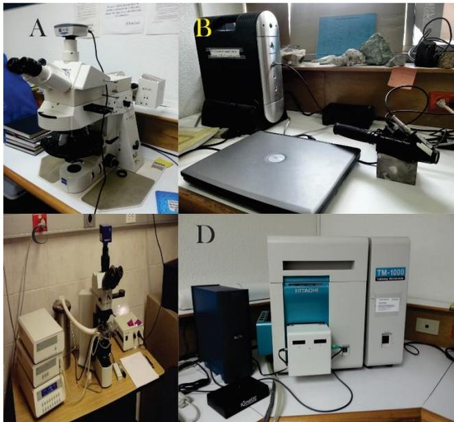
Figura 3.1. Equipo utilizado para este trabajo. A- Microscopio petrográfico, B- Espectrómetro, C- Microscopio con platina térmica, D- Microscopio electrónico de barrido.
