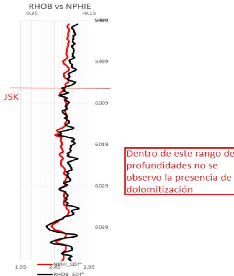
Figura 96.- Integración de datos: registro geofísico curvas (RHOB vs NPHIE); ya que dentro del rango del registro graficado no se encontró dolomitización nos apoyamos en muestras de canal (desafortunadamente no se tienen fotos del informe petrográfico).
