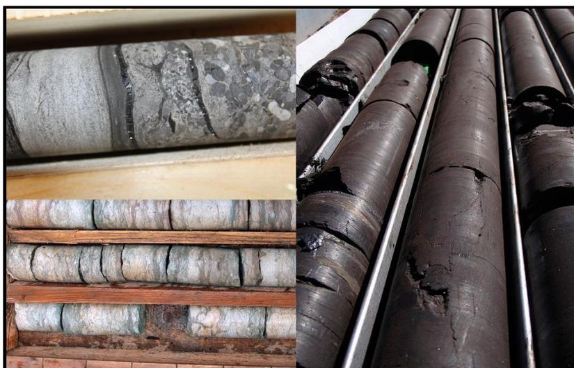
*Fig. 2.8. Secciones de núcleos limpias y acomodadas para su análisis, ya sea en el pozo o en el laboratorio.*
