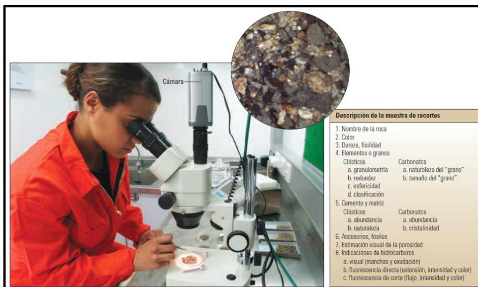
Fig.3.8. Examen microscópico de recortes (Schlumberger, 2012).
