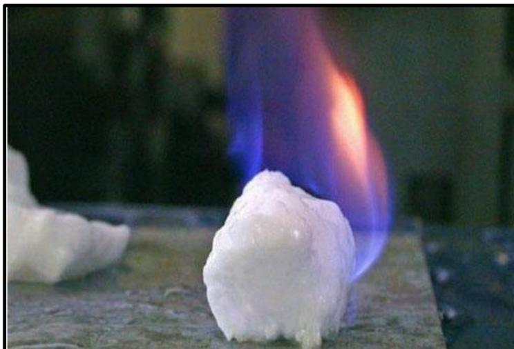
*Fig. 1.7. Hidrato de metano ardiendo (Periódico de la Energía, 2015).*
