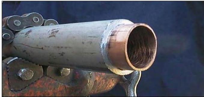
Fig. 2.3. Tubo de pared compuesta cobre-acero.
