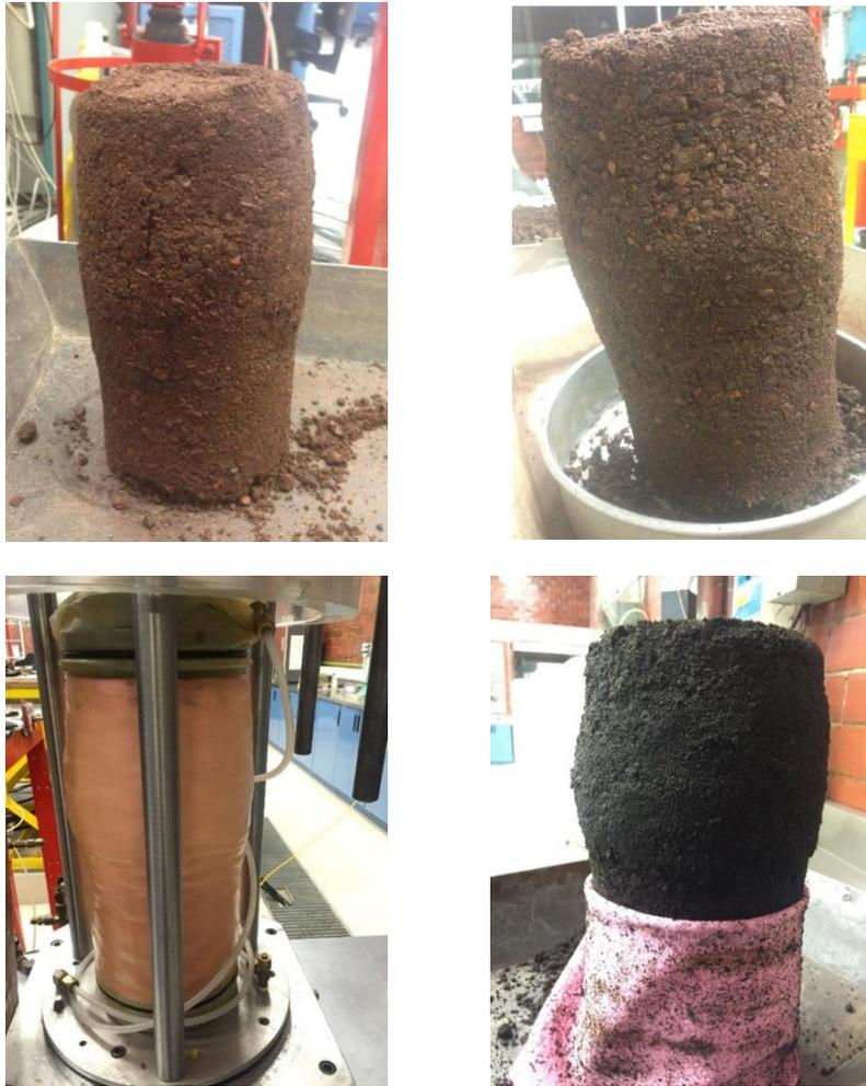
*Figura 4.51. Ensanchamiento de la probeta*
