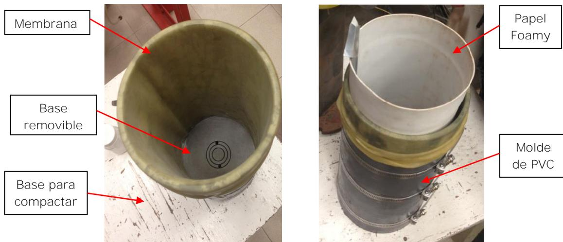
Figura 3.22. Molde para elaboración de probeta triaxial
