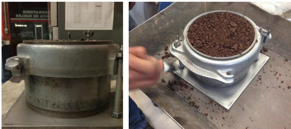
*Figura 3.19. Molde con material enrazado*
