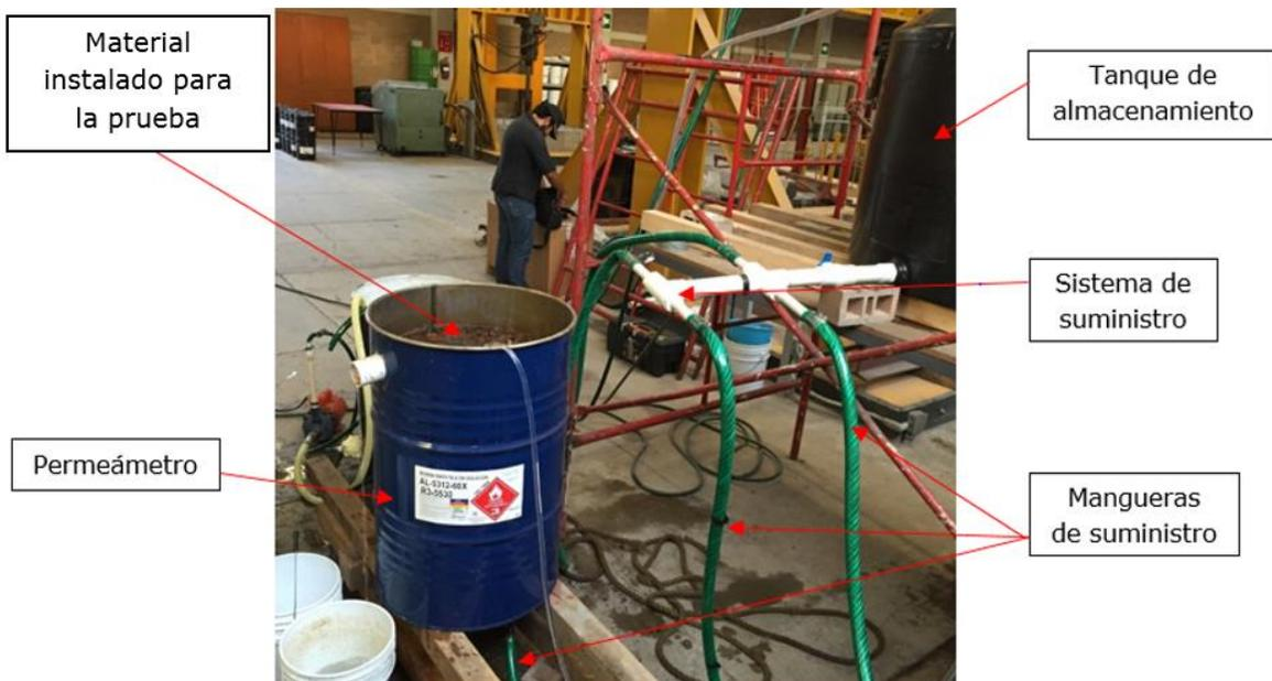
Figura 3.12. Sistema para pruebas de permeabilidad
