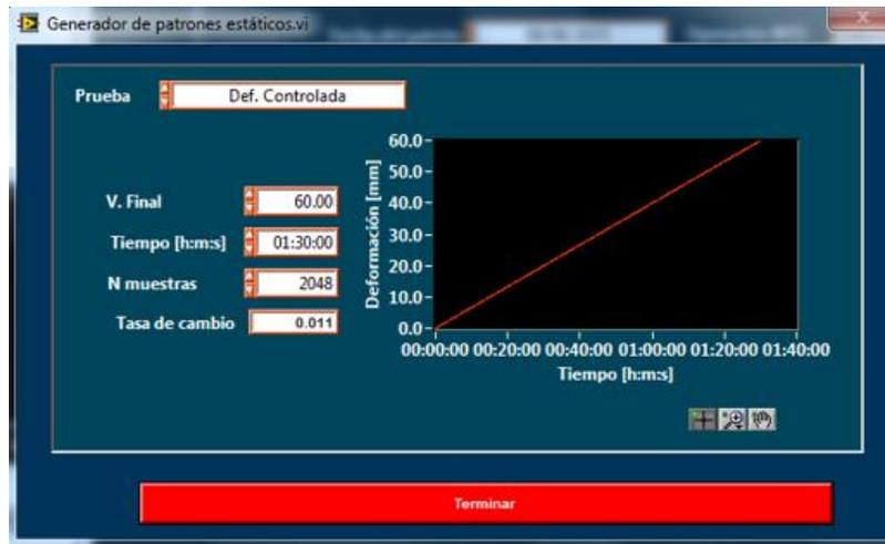
Figura 3.30. Programación del vector de desplazamiento
