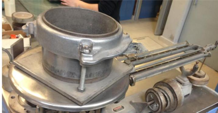
*Figura 3.18. Molde usado para determinar pesos volumétricos*
