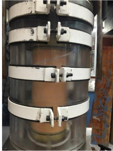
Figura 3.27. Camisa instalada y prueba lista para iniciar
