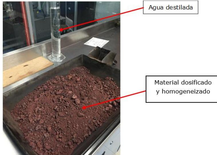
Figura 3.23. Preparación del material
