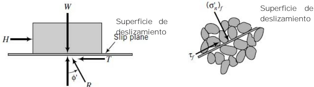
Figura 1.3. Superficie de deslizamiento en una masa de suelo
