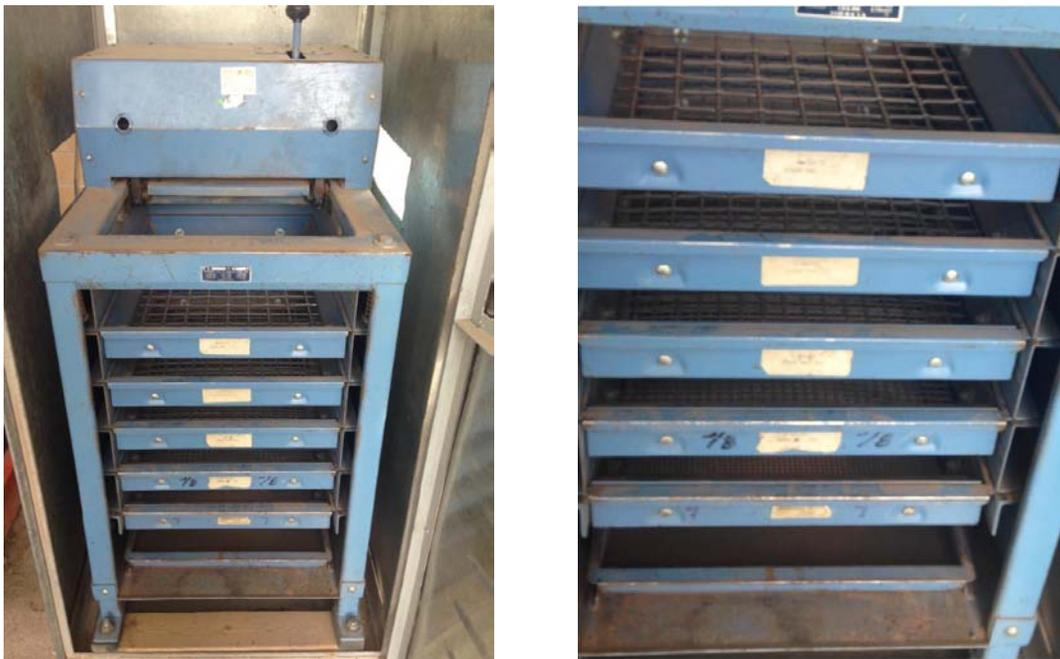
Figura 2.11. Cribadora de grandes dimensiones del Laboratorio de Vías Terrestres
