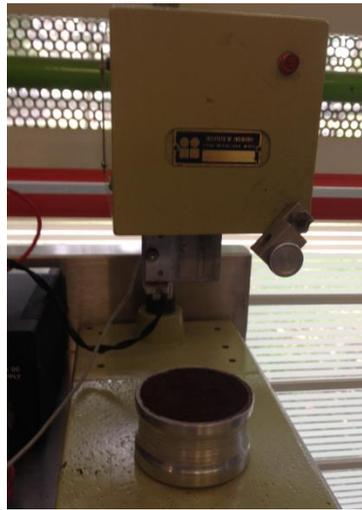
*Figura 3.1. Límite líquido mediante Cono Sueco*
