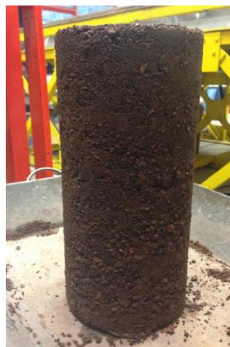
Figura 4.53. Entramado de partículas al ser compactadas
