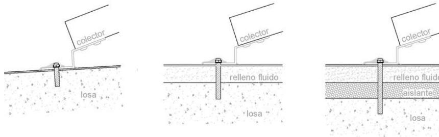
Ilustración 28 Procedimiento de anclaje del calentador solar (i-k)
