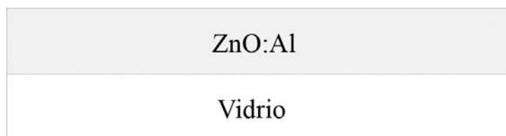
Figura 3.1. Esquema del sustrato utilizado para el depósito de la capa activa del dispositivo EL.
