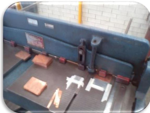
Figura 2.4.1.1 Corte de las probetas metálicas
