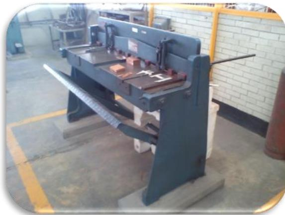
Figura 2.4.1.2 Cizalla para corte de láminas metálicas
