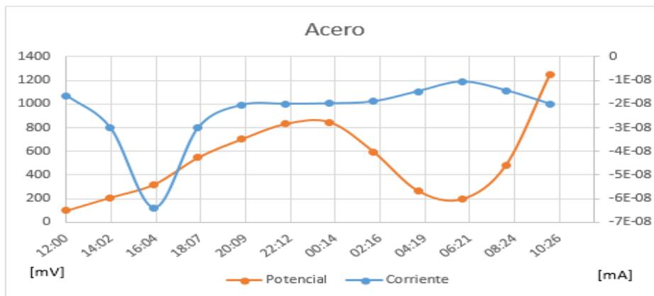
Fig. 3.3.1.7. Comportamiento del acero a lo largo de las 24 horas del monitoreo
