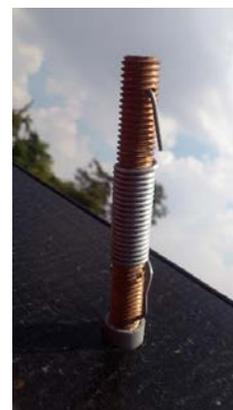
Figuras. 3.2.2.1 Imagen de las probetas de alambre de Aluminio sobre tornillos de Acero después de 90 días de exposición
