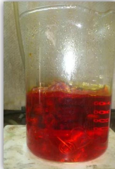
Fig. 2.5.2.1 Decapado de los alambres de Aluminio con  $H_3PO_4$  +  $CrO_3$  a  $90\text{ }^\circ\text{C}$
