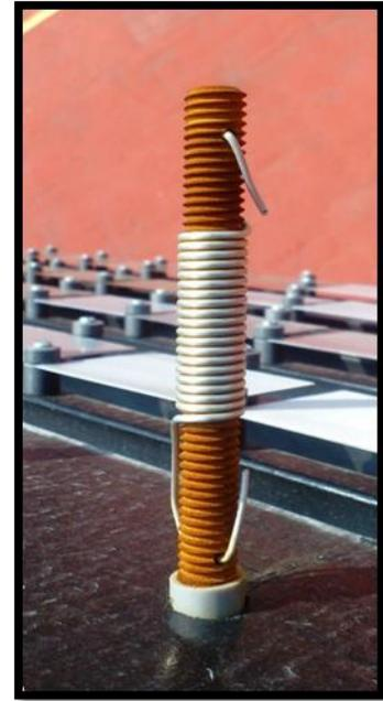
Fig. 2.5.2 Tornillo con alambre instalado, después de 30 días.
