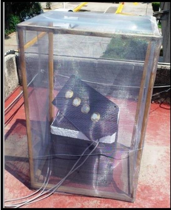
Figura 2.6.5 Sensores de Ruido Electroquímico instalados en la estación de monitoreo dentro de la caja de Faraday
