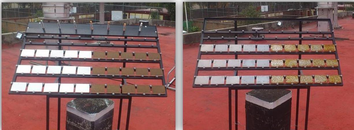
Fig. 2.4.4.4 Pupitres después de 90 días, primer retiro de probetas planas
