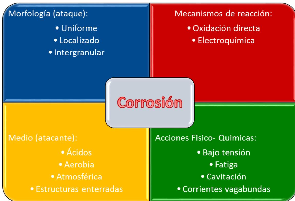
Figura 1.1.1 Clasificación de los tipos de corrosión [2]
