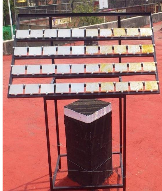
Figura 2.4.4.2 Rack con probetas de Acero y Zinc.
