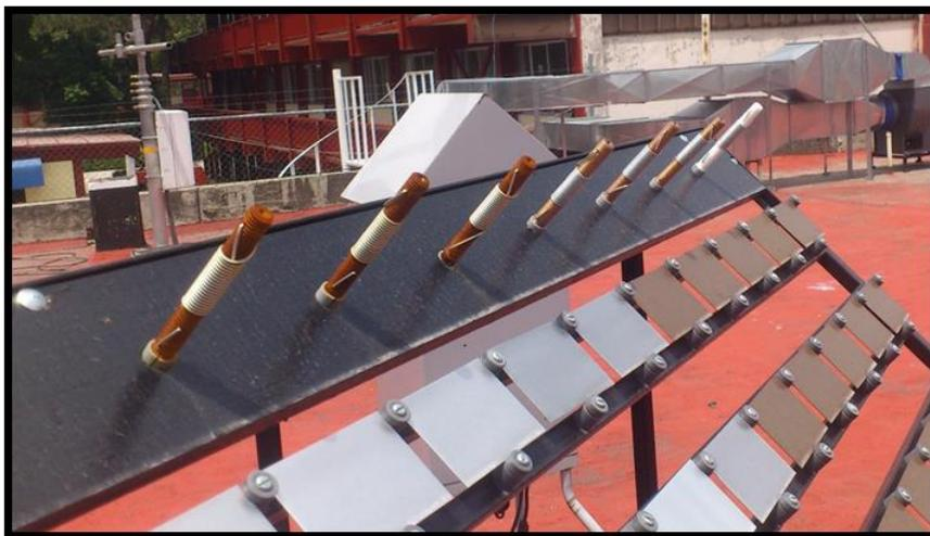
Figura 1.3.2.1 Probetas de alambre sobre tornillo.
