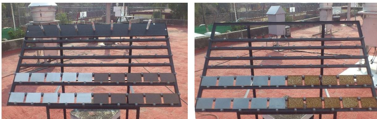
Fig. 2.4.4.5 Pupitres después de 180 días, segundo retiro de probetas planas
