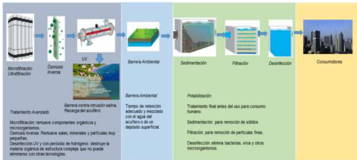
Imagen 21 Diagrama de tratamiento mediante barreras múltiples para reúso indirecto. Fuente: Chávez et al., 2015.
