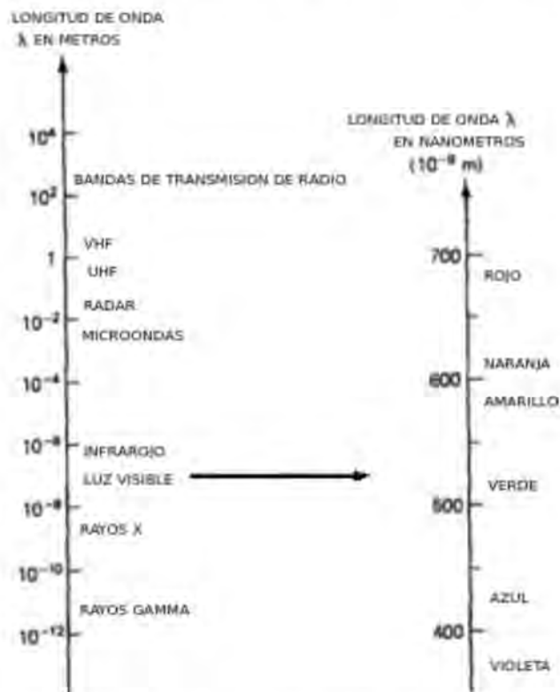
Figura 2.10: Ubicación del espectro visible dentro del espectro electromagnético
