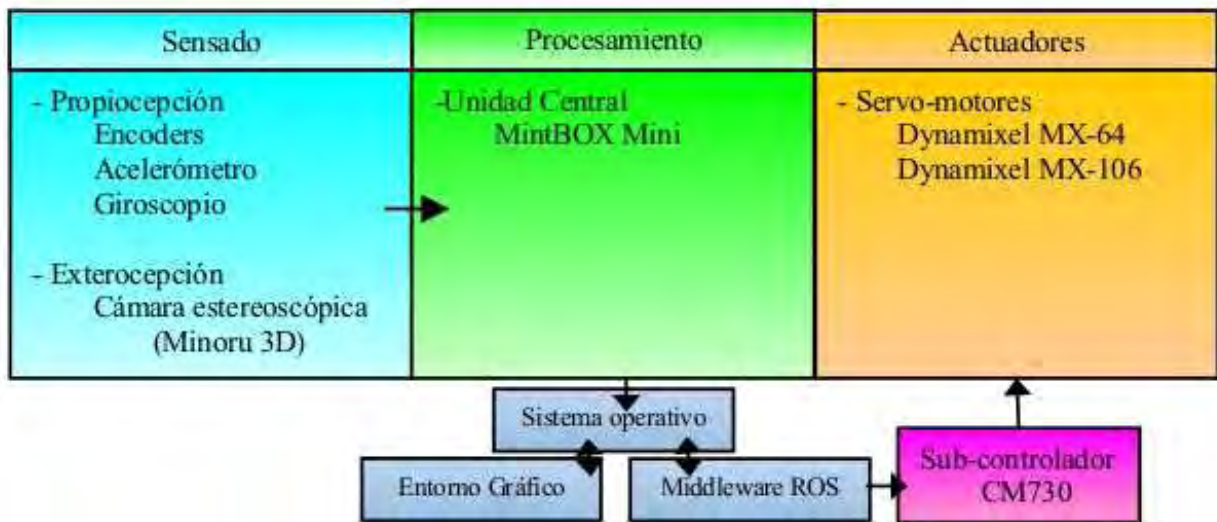
Figura 3.12: Diagrama de los componentes de Nimbro.
