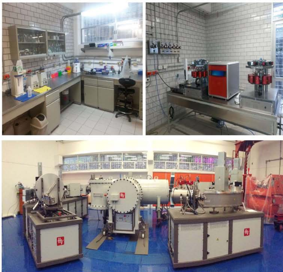
Figura 4-1: Laboratorios con los que cuenta en LEMA: Laboratorio de preparación de muestras (arriba-izquierda), laboratorio de grafitización (arriba-derecha) y separador isotópico con un acelerador tipo Tandetron de 1.0 MV (abajo).
