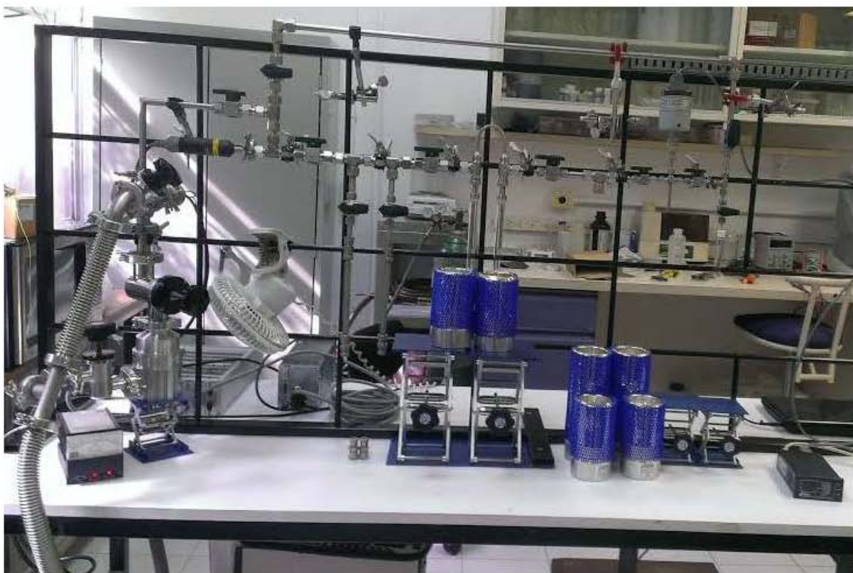
Figura 4-10: Fotografía de línea para limpieza y traspaso de muestras con sistema de vacío.
