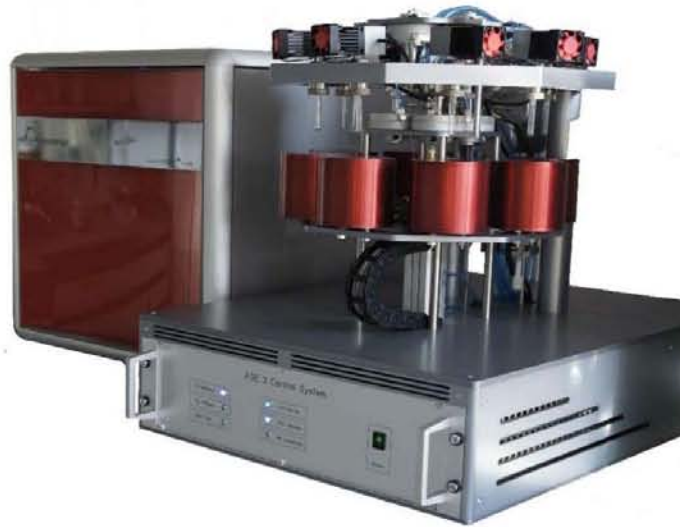
Figura 4-3: Equipo de grafitización automatizada AGE 3. Imagen tomada de [20].
