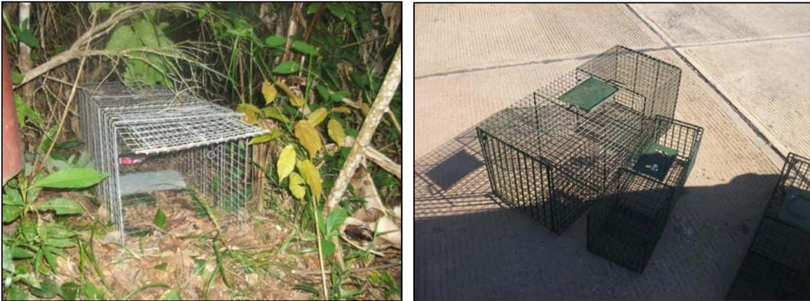
Figura 8. Trampas Tomahawk utilizadas para colecta de mamíferos de talla mediana. Modelo plegable de 32 x 10 x 12” (Izquierda); trampas modelo no plegable (Derecha), tamaños 32 x 10 x 12” y 26 x 9 x 9”. (Fotos Edwin Batalla)
