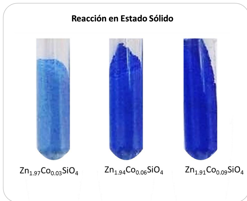
Figura 3.13 Pigmentos de Zn_{2-x}Co_xSiO_4 para x = 0.03, 0.06 y 0.09 obtenidos a 1400^\circ C por el método de reacción en estado sólido.
