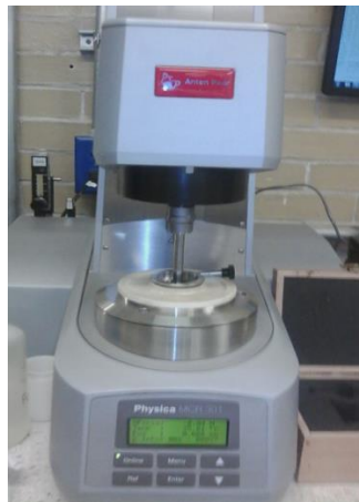
Figura 4.3 Reómetro DHR-3 en el que se midió la viscosidad del crudo Maya
