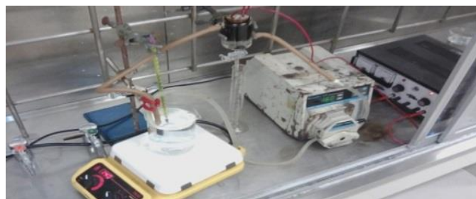
Figura 3.5 Equipo experimental durante el desalado de crudo
