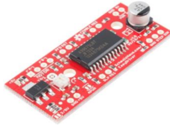
Figura 49. Driver controlador de motores a pasos modelos EasyDriver © de la empresa SparkFun ® [67]
