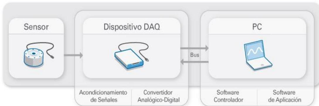
Figura 9. Módulo de adquisición de datos
