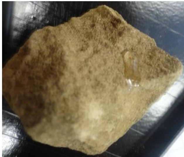
Figura II. 4.- Muestra 4 de núcleos del pozo X-1, arenisca calcárea.
