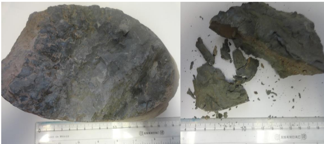
Figura II. 8.- Muestra 1 de núcleos del pozo O, caliza arcillosa.
