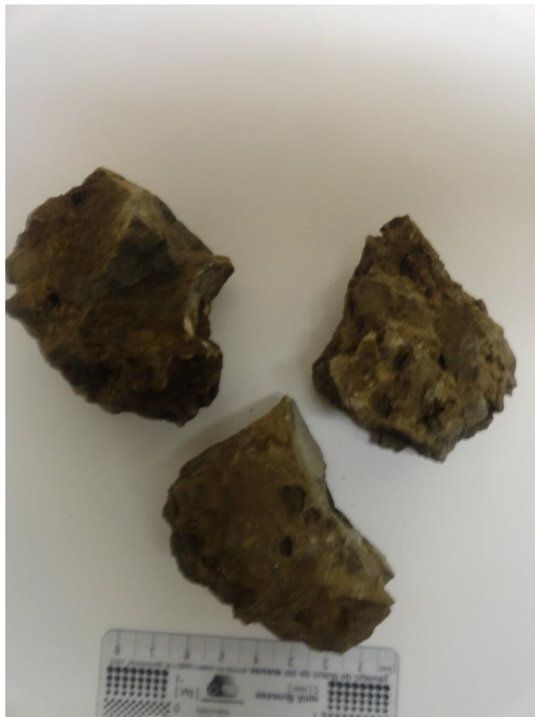
Figura II. 23.- Muestra de núcleo del pozo X-10, dolomita.
