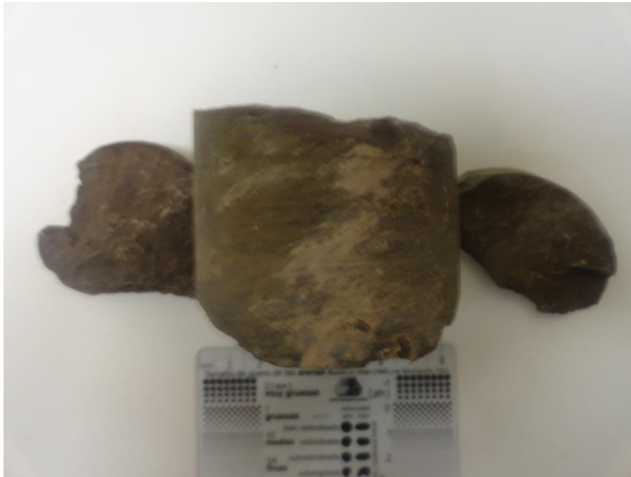
Figura II. 21.- Muestra 2 de núcleos del pozo X-8, lutita.
