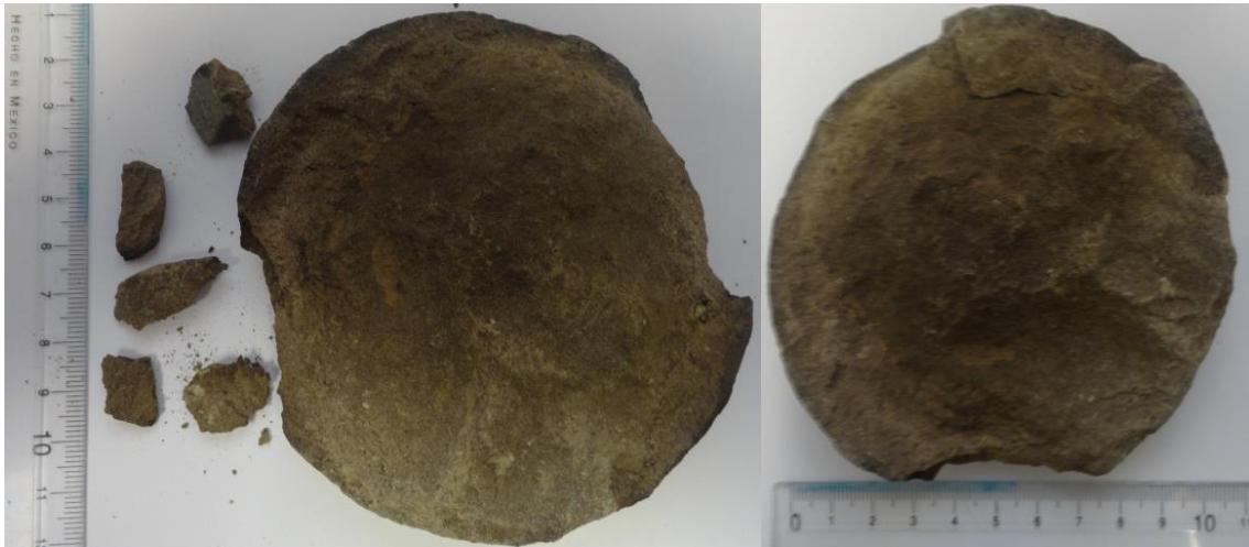
Figura II. 9.- Muestra 2 de núcleos del pozo O, arenisca calcárea.
