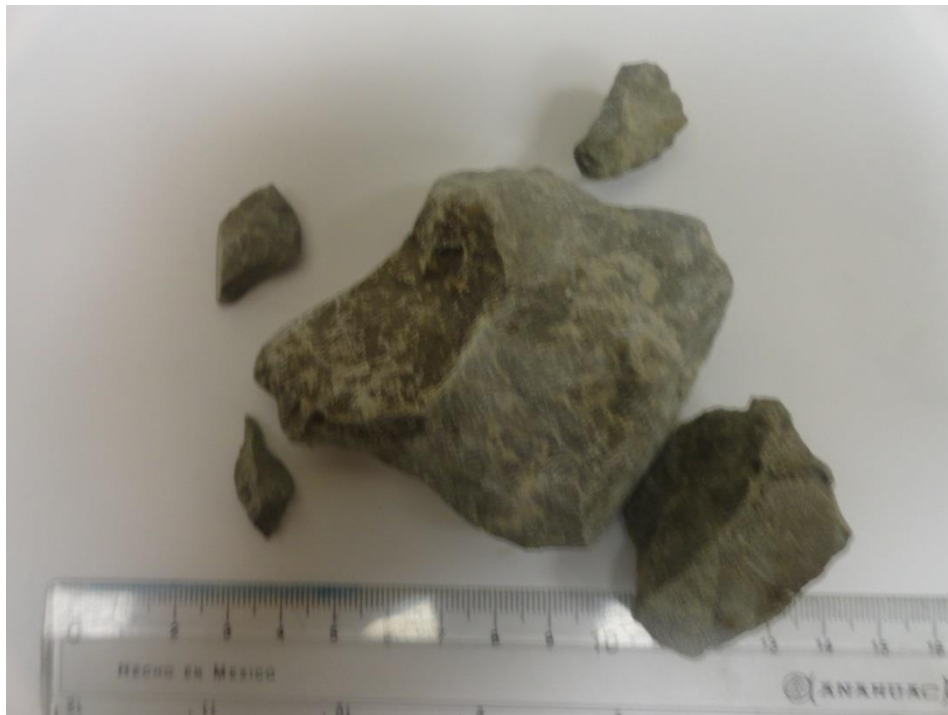
Figura II. 14.- Muestra de núcleo del pozo X-4, calcita.
