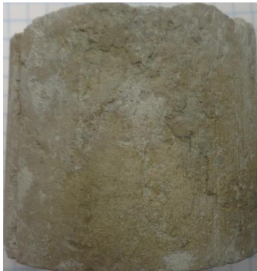
Figura II. 6.- Muestra 6 de núcleos del pozo X-1, arenisca calcárea.
