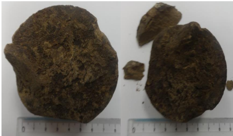
Figura II. 7.- Muestra 7 de núcleos del pozo X-1, arenisca calcárea.
