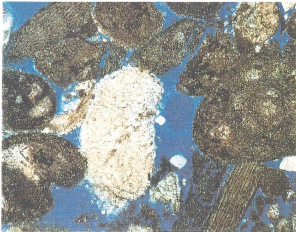
Figura 18.- Microfotografa de la seccin delgada ilustrando el dominio de la porosidad interpartcula entre granos alioqumicos. Estos alioqumicos son dominados por peloides micrticos, foraminfera bentnica, intraclastos y fragmentos algceos.
