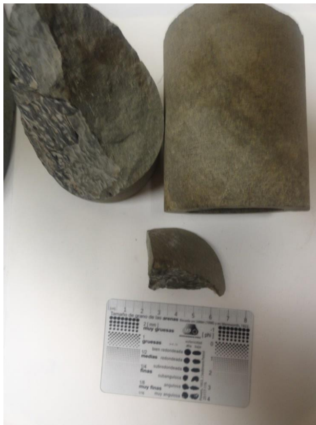
Figura II. 19.- Muestra de núcleo del pozo X-7, lutita calcárea.
