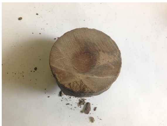
Figura 24.- Muestra 5: O, roca de tipo arenisca calcárea.
