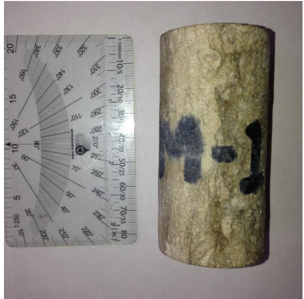
Figura 26.- Tapón extraído del núcleo del pozo N para realizar pruebas petrofísicas.
