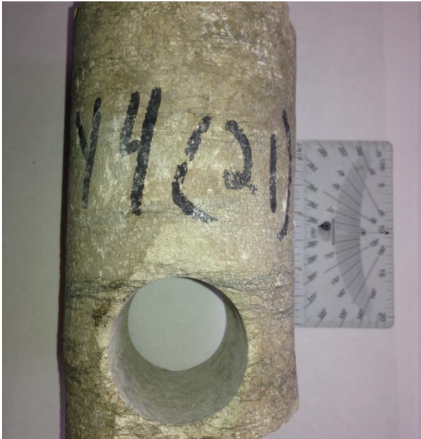
Figura 25.- Núcleo de la formación de arenisca calcárea de grano fino extraído del pozo N.
