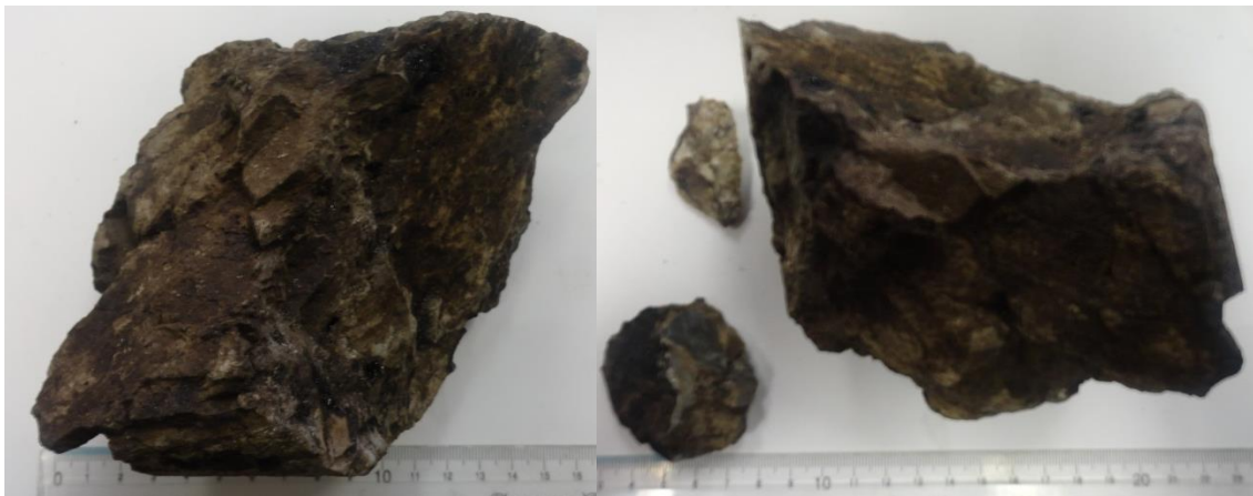
Figura II. 13.- Muestra de núcleo del pozo X-3, dolomita masiva.
