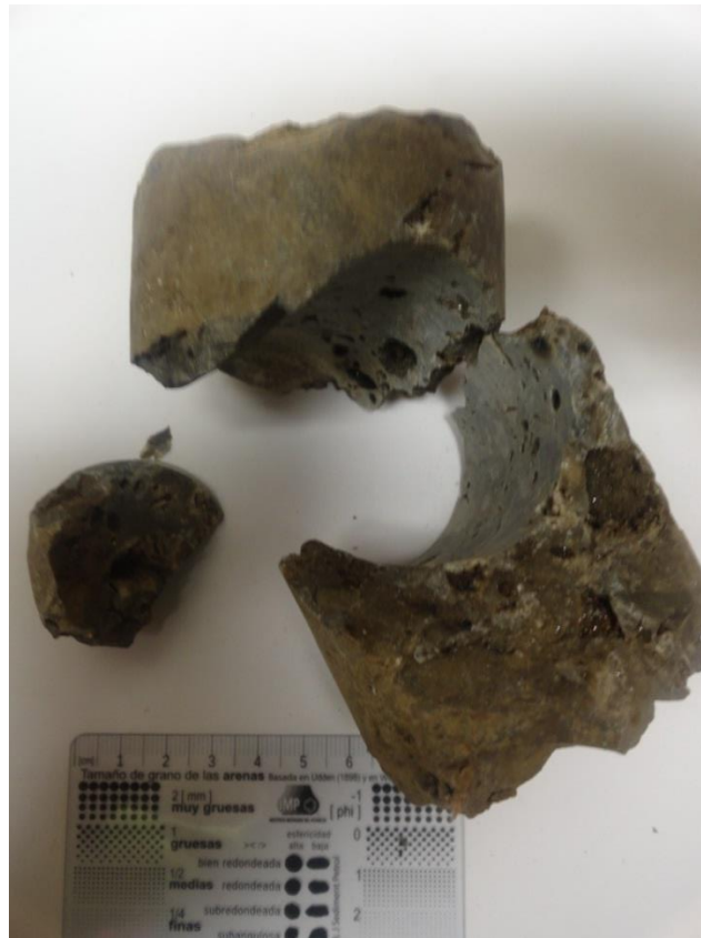
Figura II. 17.- Muestra 2 de núcleos del pozo X-6, caliza.
