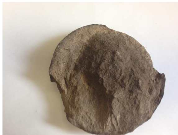
Figura 22.- Muestra 3: O, roca de tipo arenisca calcárea.
