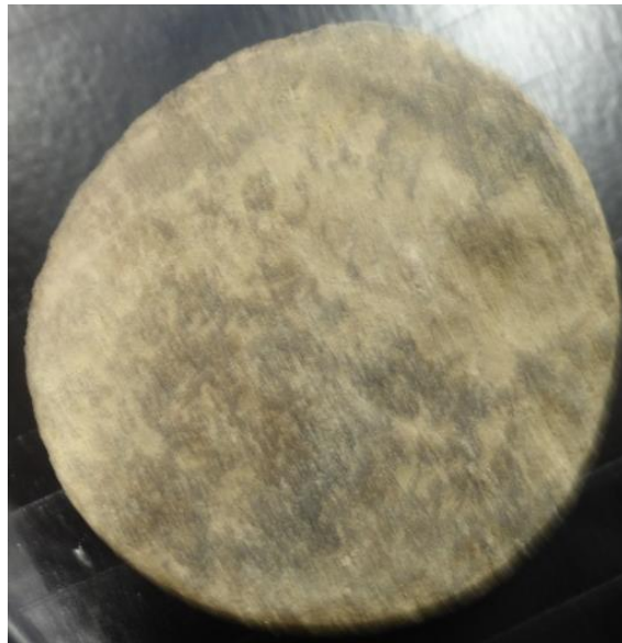
Figura II. 5.- Muestra 5 de núcleos del pozo X-1 arenisca calcárea.
