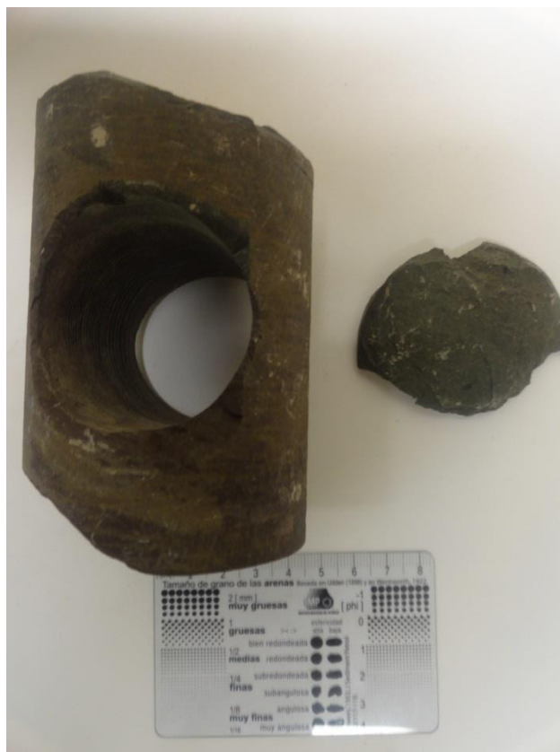
Figura II. 20.- Muestra 1 de núcleos del pozo X-8, lutita.
