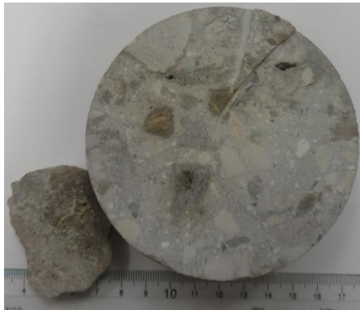
Figura II. 12.- Muestra de núcleo del pozo X-2, brecha calcárea.
