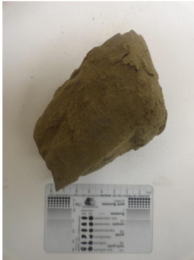
Figura II. 22.- Muestra de núcleo del pozo X-9, limolita arcillosa.
