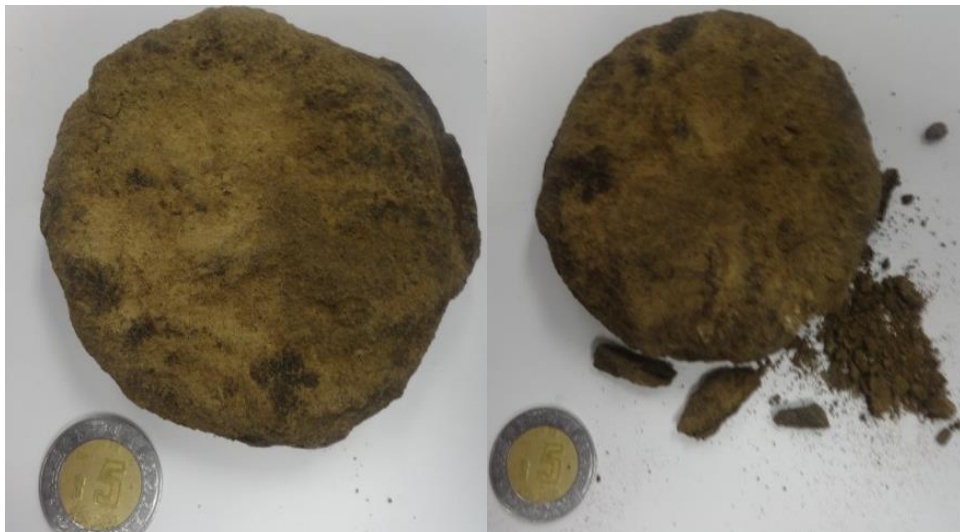
Figura II. 11.- Muestra 4 de núcleos del pozo O, arenisca calcárea.
