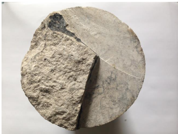
Figura 23.-Muestra 1: Pozo N, roca del tipo Arenisca calcárea.
