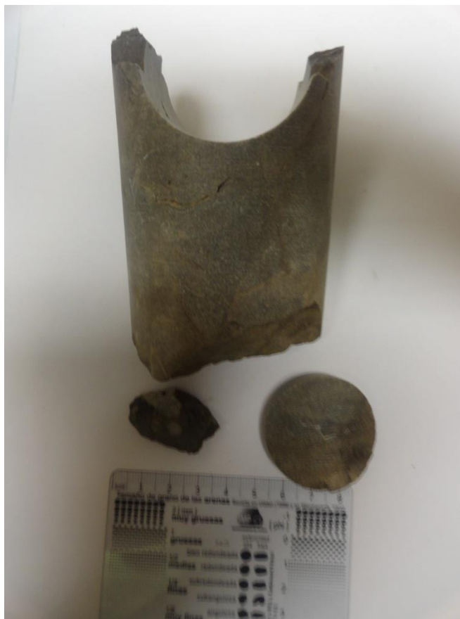
Figura II. 16.- Muestra 1 de núcleos del pozo X-6, caliza.
