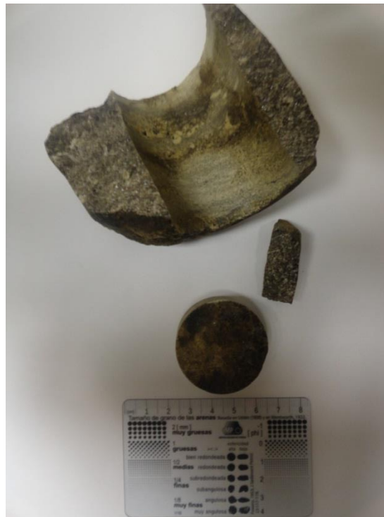
Figura II. 15.- Muestra de núcleo del pozo X-5, dolomía.
