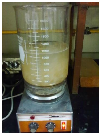
Figura 9. Proceso para la obtención de quitosán
