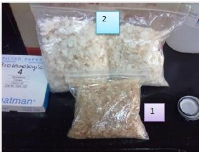
Figura 22. Bolsa marcada con el número 1 es quitina y bolsa marcada con el número 2 es quitosán
