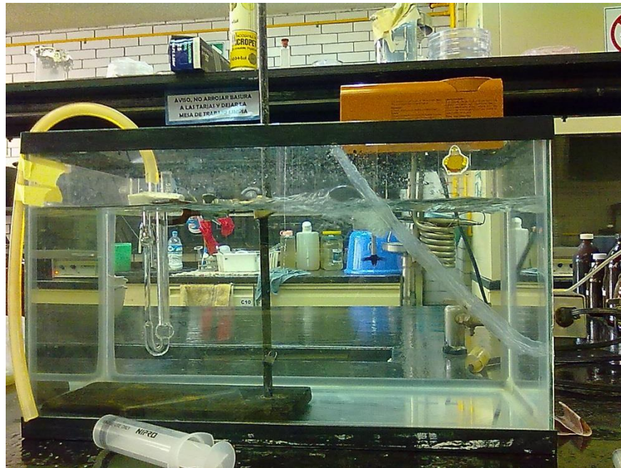
Figura 13. Determinación de peso molecular del quitosán por viscosimetría.
