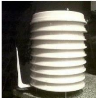
Figura 3.3. Pantalla con ventilación artificial
