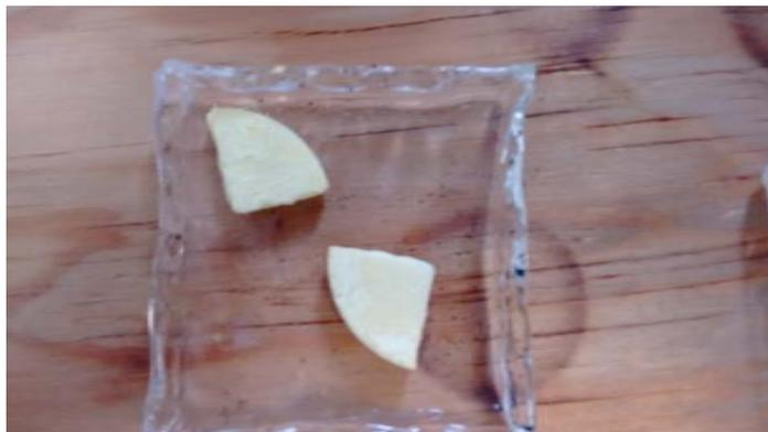
Figura 10: Filtros con depósito de  $Bi_2O_3$
