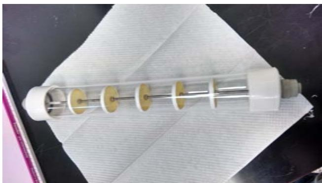
*Figura 35: Filtros soportados dentro del tubo receptor.*
