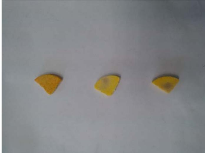
Figura 21: Filtros después del proceso con MO. El pH del colorante utilizado de izquierda a derecha fue 3.1, 8.59 y 11.48.
