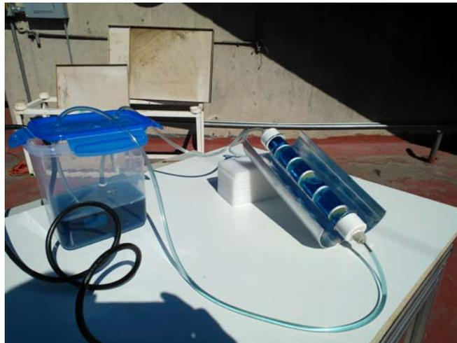
*Figura 37: Prueba de decoloración del IC en el reactor solar.*
