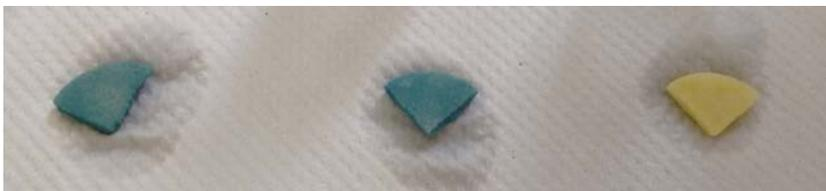
Figura 22: Filtros después del proceso. El pH del colorante utilizado de izquierda a derecha fue 2.98, 5.88 y 11.66.
