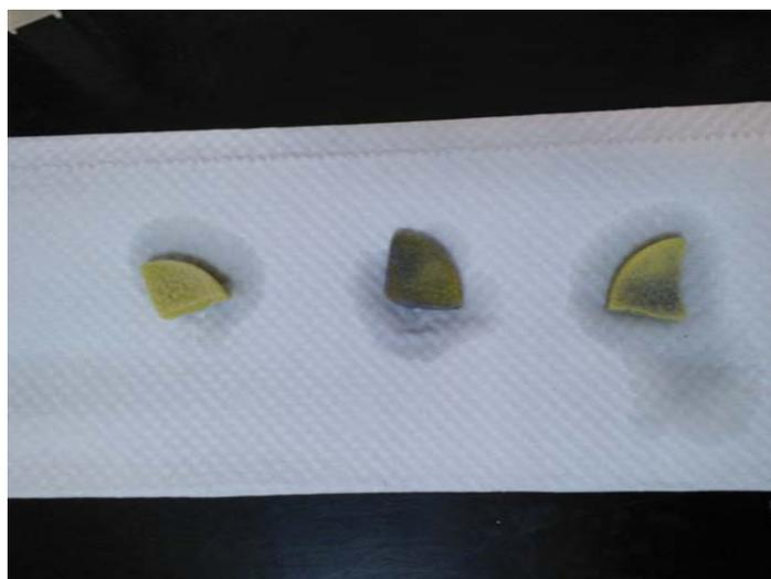
Figura 20: Filtros después del proceso con AA113. El pH del colorante utilizado de izquierda a derecha fue 3.24, 9.48 y 12.21.
