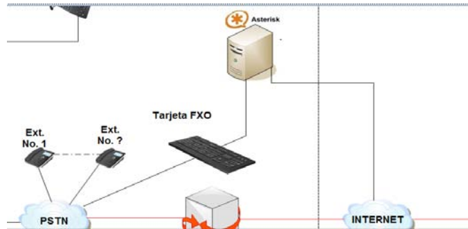
Fig. 5.87 Representación de la conexión de un PBX a la PSTN por medio de una tarjeta FXO.
