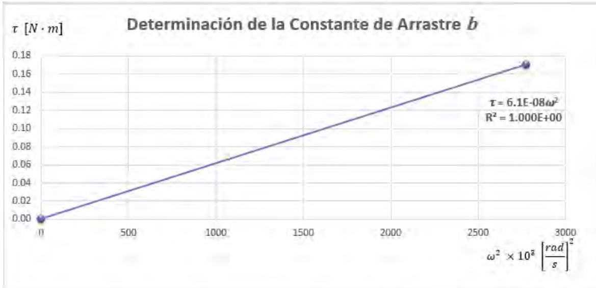
Figura A.4-7. Gráfica de empuje contra el cuadrado de la velocidad angular para el par motor-propela.
