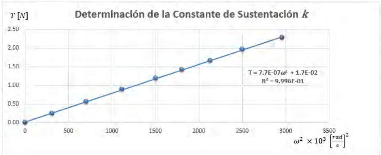
Figura A.4-6. Gráfica de empuje contra el cuadrado de la velocidad angular para el par motor-propela.
