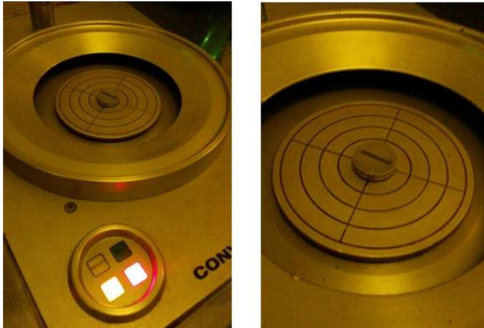
**Fig. 4. 8. Colocación de muestra dentro de spin-coating.**
