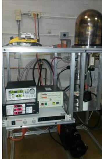
**Fig. 4. 15. Estación utilizada para realizar el depósito por evaporación.**
