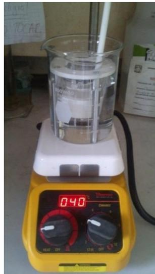
**Fig. 4. 12. Calentado de ácido fosfórico para realizar el ataque químico.**
