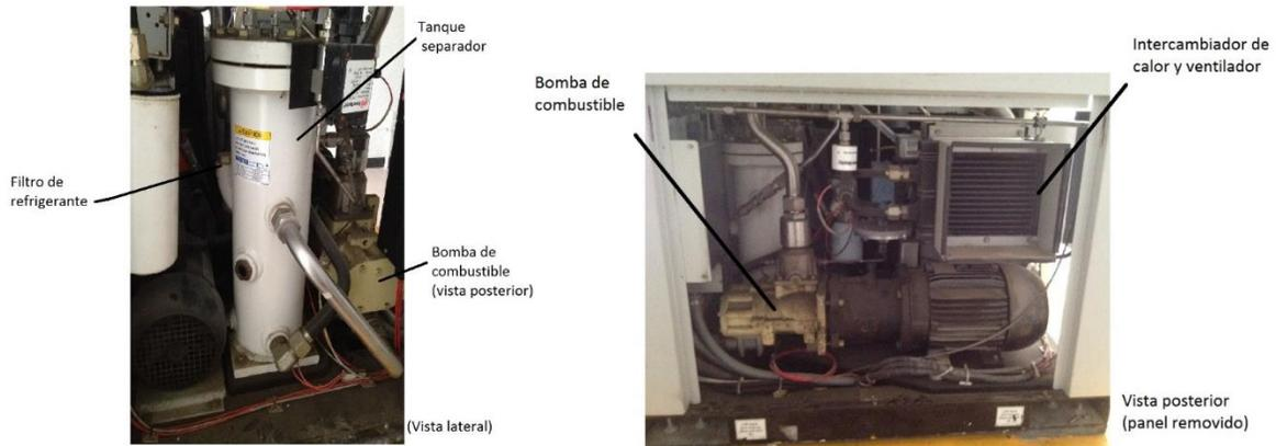
Figura 23) Componentes principales del sistema de combustible.
