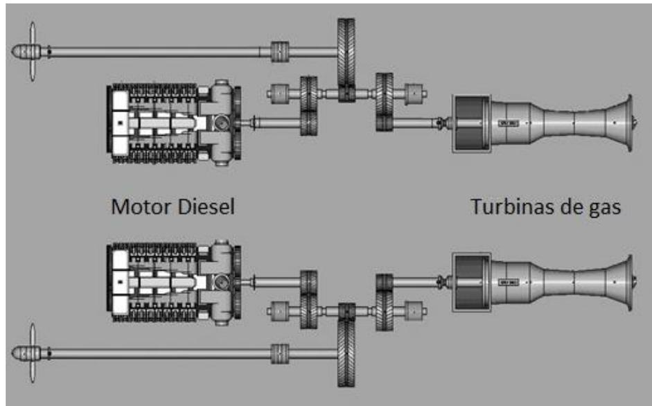
Figura 4) Esquema del funcionamiento en conjunto de un motor diésel y una turbina de gas (modificado de Anónimo, Modernización de los Destruyores Clase Almirante Brown, 2014).
