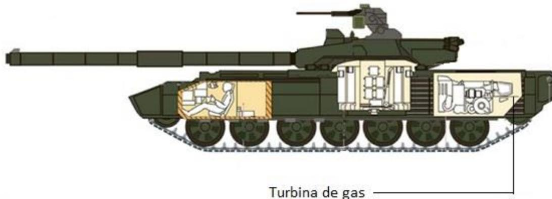
Figura 5) Esquema de la ubicación de una turbina de gas en un tanque de guerra (modificado de Huard, 2015).
