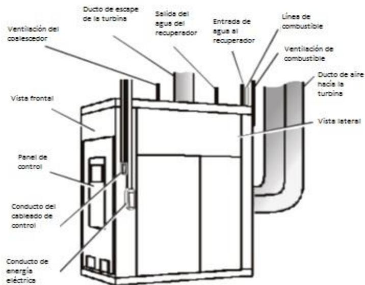
Figura 16) Conexiones externas de la microturbina (modificado de Ingersoll-Rand Energy Systems, 2002).
