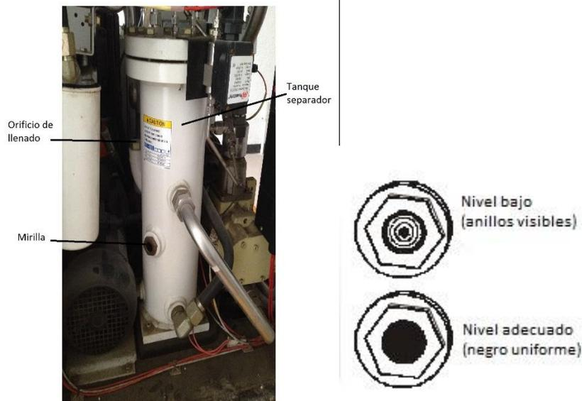
Figura 39) Depósito de refrigerante de la bomba de combustible (modificado de Ingersoll-Rand Energy Systems, 2002).
