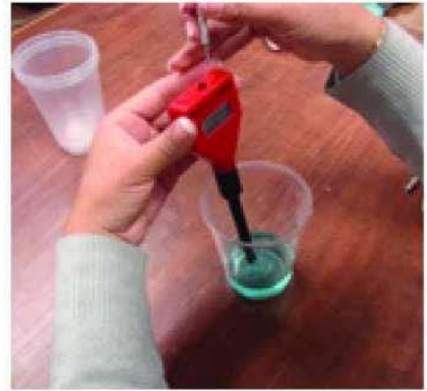
**Img. El potenciómetro se debe calibrar para tomar una lectura correcta del pH.**
