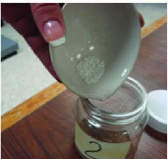
**Img.Depositando el estabilizador en los 7 recipientes con el suelo seleccionado.**
