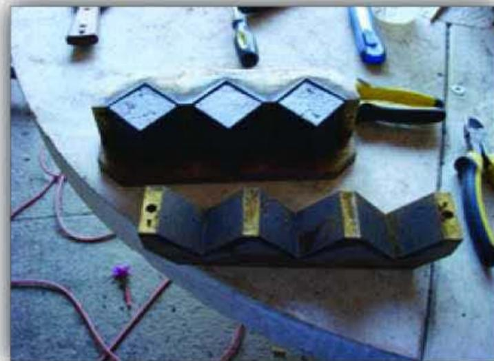
**Img. Desmolde de los cubos.**
