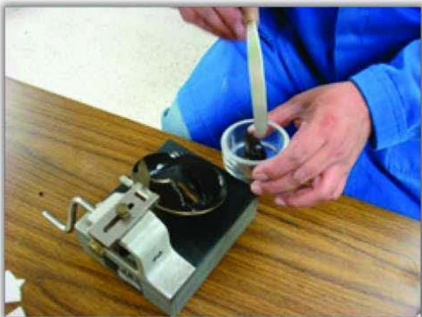
**Img.Tomar la Muestra para Determinar Humedad**
