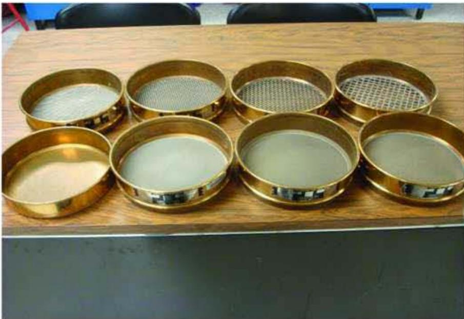
**Img. Diferentes tamices, en buen estado y limpios.**
