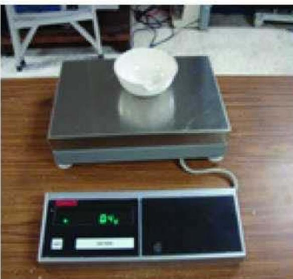
**Img.Pesando el estabilizador que vamos a usar.**
