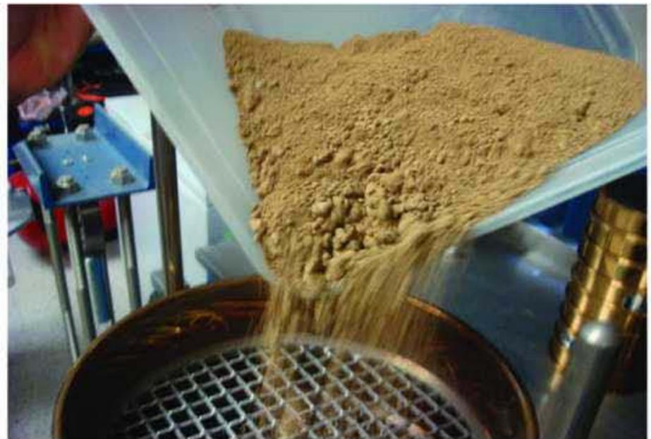
**Img. Al depositar la muestra en los tamices debemos tener cuidado de no derramarla.**
