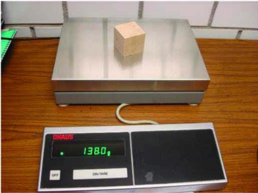
**Img. El espécimen no pierde material al saturarse.**
