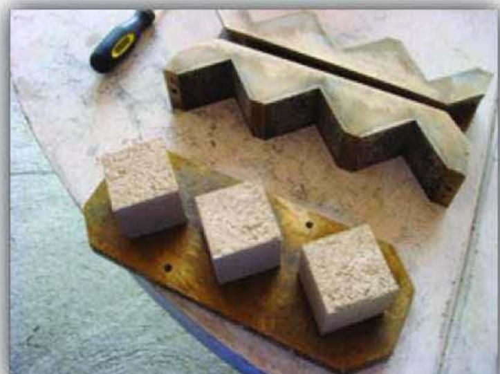
**Img. Desmolde de los cubos.**
