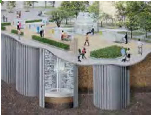
Automatic underground bike parking- Japón. Giken
