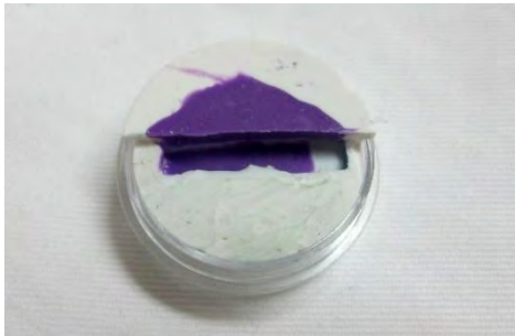
Imagen 32. Impresión con silicona de la muestra "inicial". Fuente directa.
