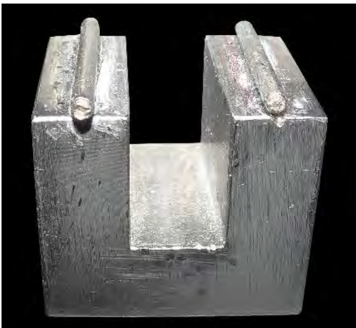
Imagen 55. Apoyos colocados en el soporte a una distancia de 15 milímetros entre sí. Fuente directa.
