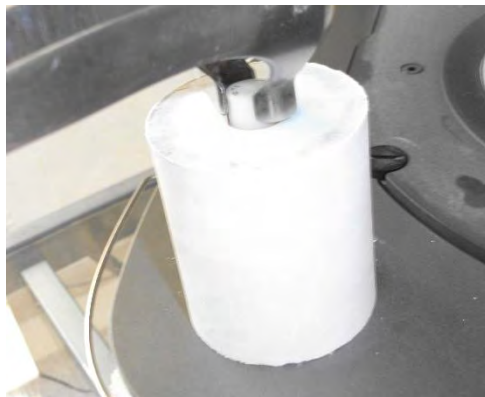
Imagen 48. Colocación de la pastilla en el cilindro. Fuente directa.
