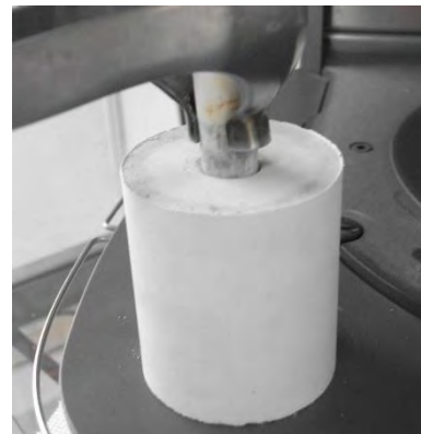
Imagen 49. Colocación del pistón en el cilindro. Fuente directa.
