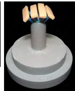
Imagen 36. Patrones de cera colocados en la base del cilindro. Fuente directa.
