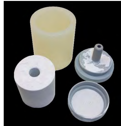
Imagen 42. Cilindro de revestimiento. Fuente directa.
