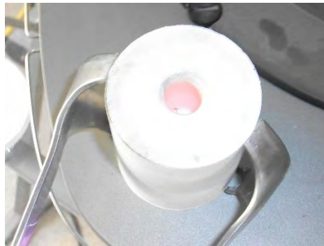
Imagen 46. Cilindro posicionado en el horno de inyección inmediatamente después de retirado del horno de desecado. Fuente directa.
