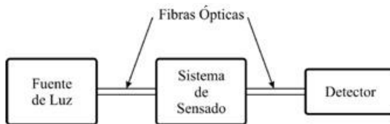
Figura 1.1. Esquema básico de un sensor en fibra óptica.
