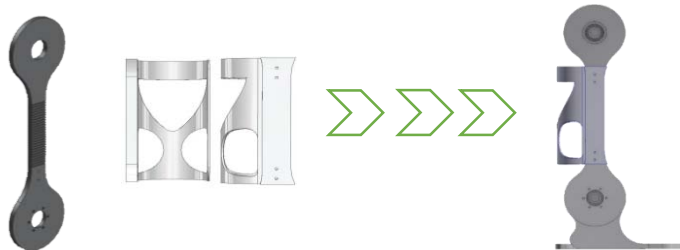
Figura A.2 Vistas del eslabón tibial y el soporte. Ambos sujetan la pantorrilla y el pie.
