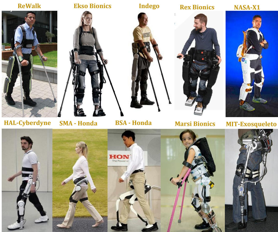
Figura 1.3 Exoesqueletos recientes orientados a la rehabilitación de personas con discapacidades motoras de miembros inferiores. Bodyweight Support Assist (BSA) , Stride Management Assist (SMA)
