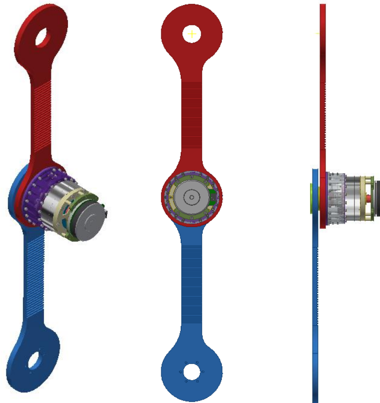
Figura 4.17 Representación del SA sobre los eslabones del exoesqueleto para la pierna izquierda.
