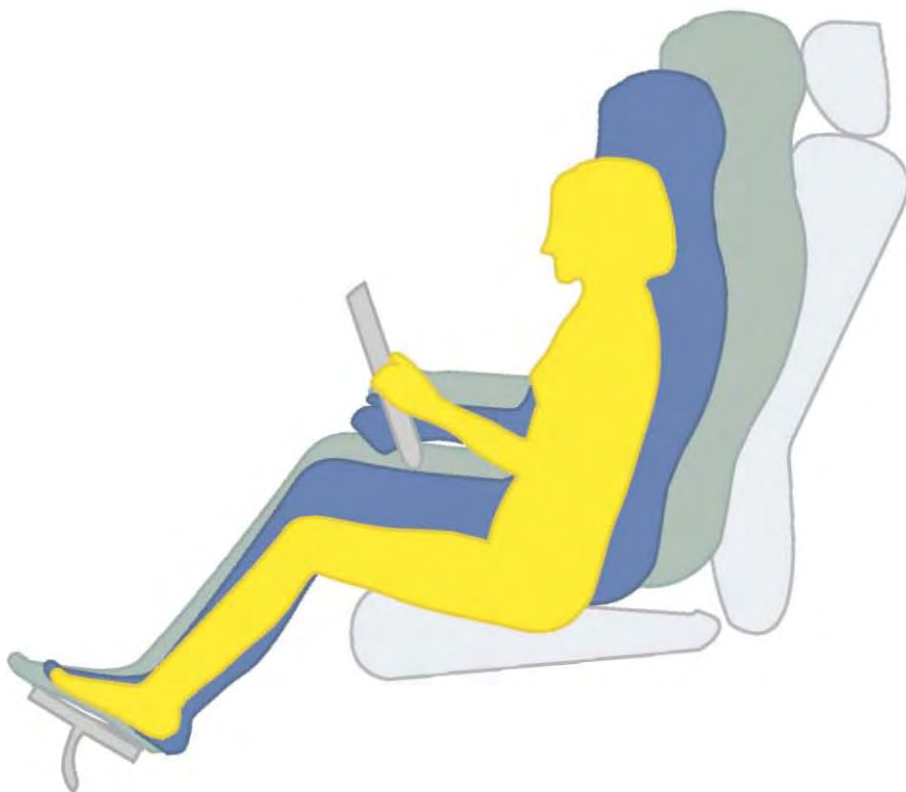
Figura 3.7: Comparación de asiento con diferentes antropometrías: mujer pequeña, hombre promedio y hombre extremo .
