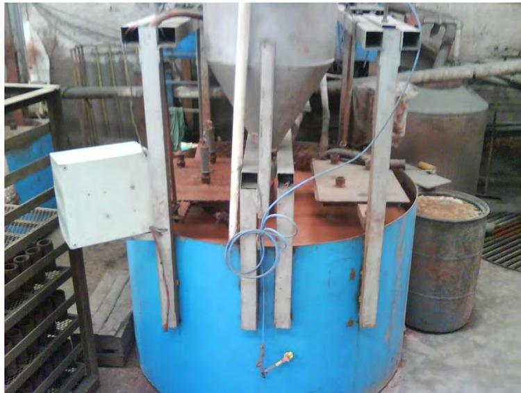
*Figura 6.4 Máquina formadora de camisas exotérmicas*
