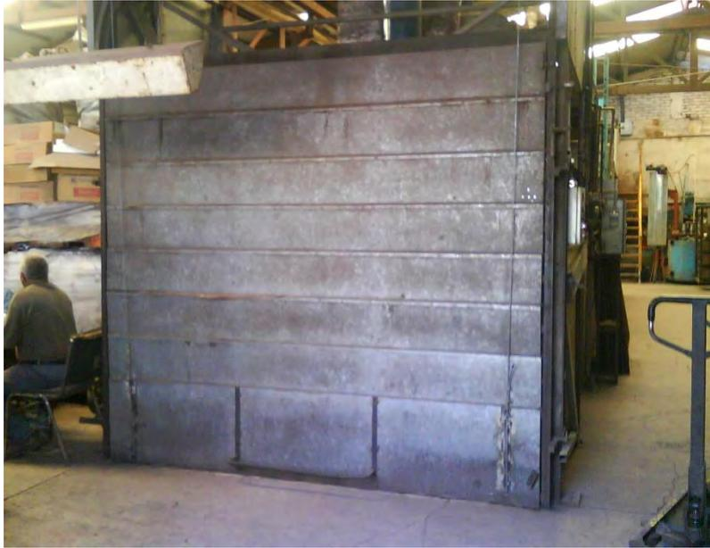
*Figura 6.5 Horno utilizado para realizar camisas exotérmicas.*
