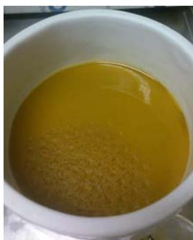
9. El material de color amarillo se suspende en agua, inmediatamente después de lavar el material, y se exfolia, buscando tener una disolución de concentración de **GTO** 1 g/L, terminado el proceso de exfoliación se obtiene **GO<sub>1</sub>** (óxido de grafeno tipo I). Las exfoliaciones se realizan en un baño de ultrasonido Cole-Parmer Modelo 8891-21 de 100 W.
