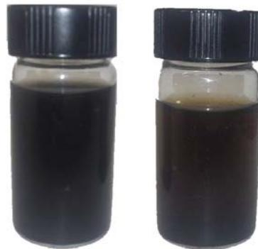
Una de las propiedades interesantes de estos dos materiales es que el  $\text{GO}_2$  se mantienen suspendido durante 72 horas mientras que el  $\text{GO}_1$  se mantiene estable por mucho tiempo aunque con una cantidad de material precipitado en el fondo. El  $\text{GO}_1$  se ha mantenido durante más de un año en suspensión (marzo del 2014 a junio del 2015, último reporte en tesis).
