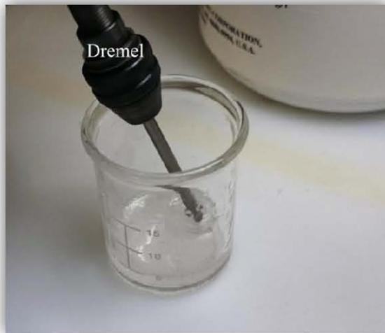
Fig. 4.10 Mezclado de PDMS.
