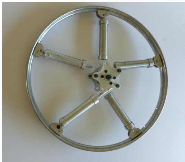
Figura 63. Diseño final de la rueda, hecha en aluminio con cinco amortiguadores finales como brazos.
