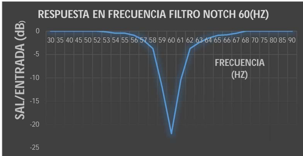
Figura 6.1.22 Respuesta en frecuencia del filtro Notch 60[Hz]. Obtenido prácticamente.
