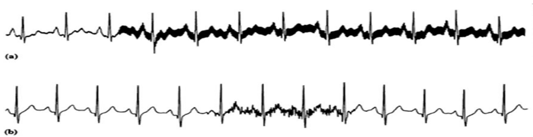
(a) Tensión alterna de 60 Hz en la línea de alimentación (b) Actividad muscular
