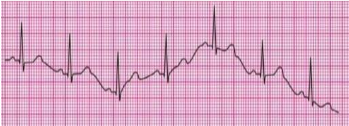
Figura 2.21 Desplazamiento de la línea de base. [68]
