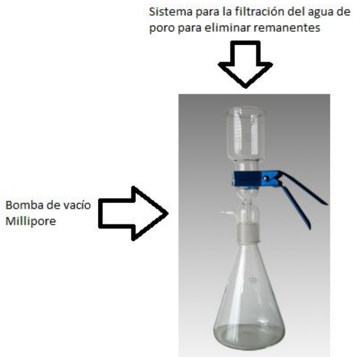
Figura 16. El agua de poro es filtrada para retirar remanentes de partículas sólidas de tamaño considerable.
