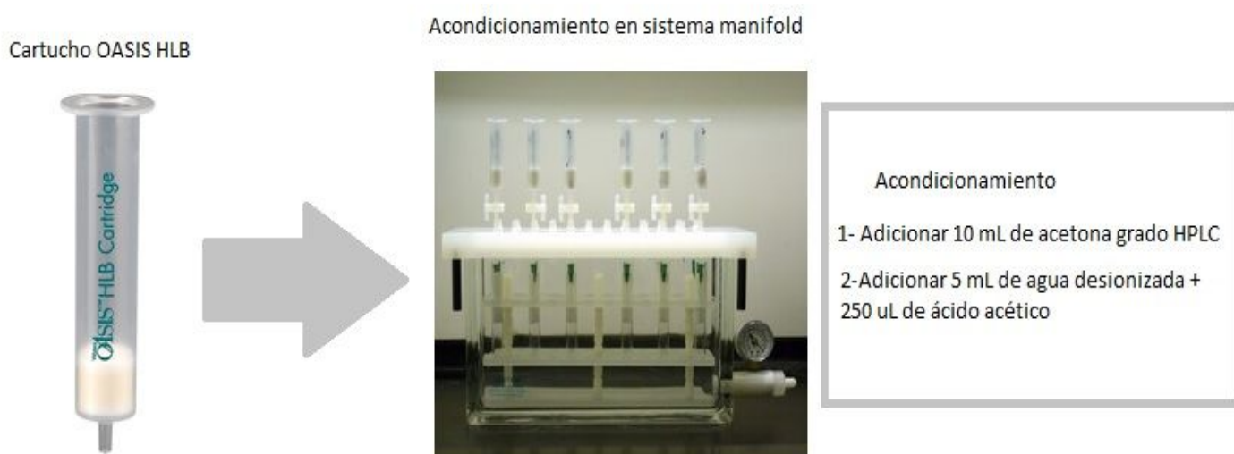
Figura 19. Acondicionamiento de cartuchos en Sistema Manifold con los cartuchos SPE OASIS HLB ® 6 cc.
