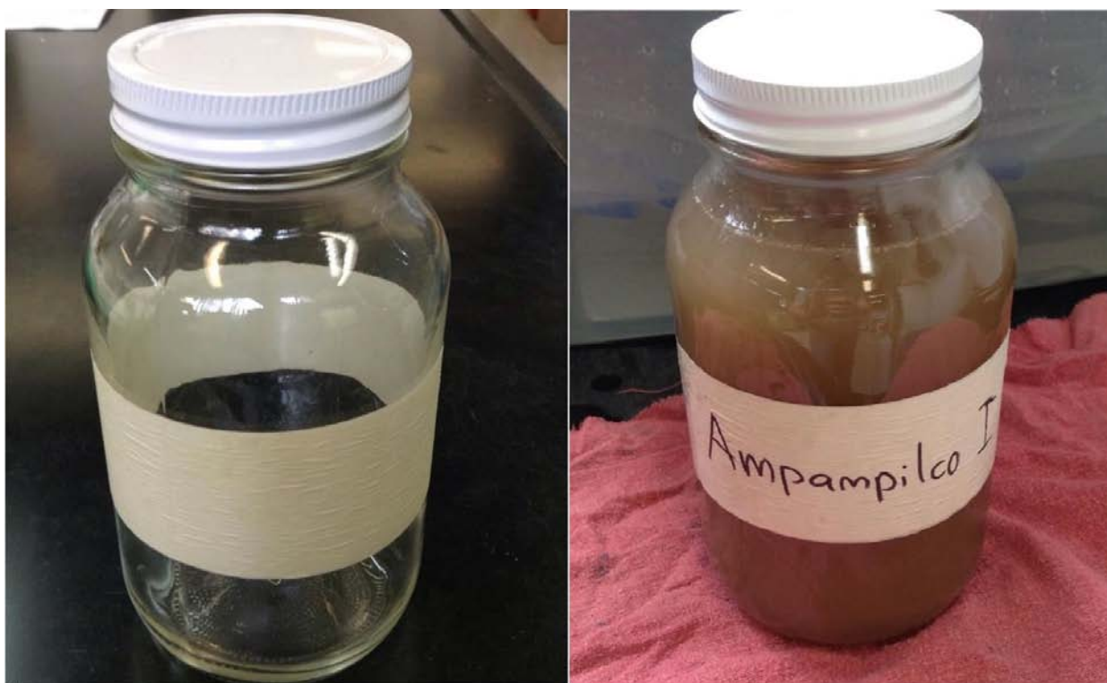
Figura 8. Frascos de vidrio de boca ancha y tapa de aluminio utilizados para el muestreo.
