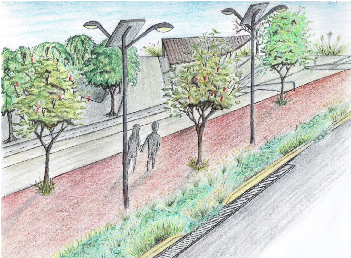
Figura 62. Área de acceso al parque en donde se aprecian drenes filtrantes a nivel de banqueta.
