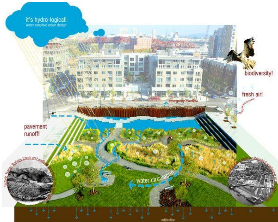
Figura 45. Captación de agua pluvial dentro del parque. 64
