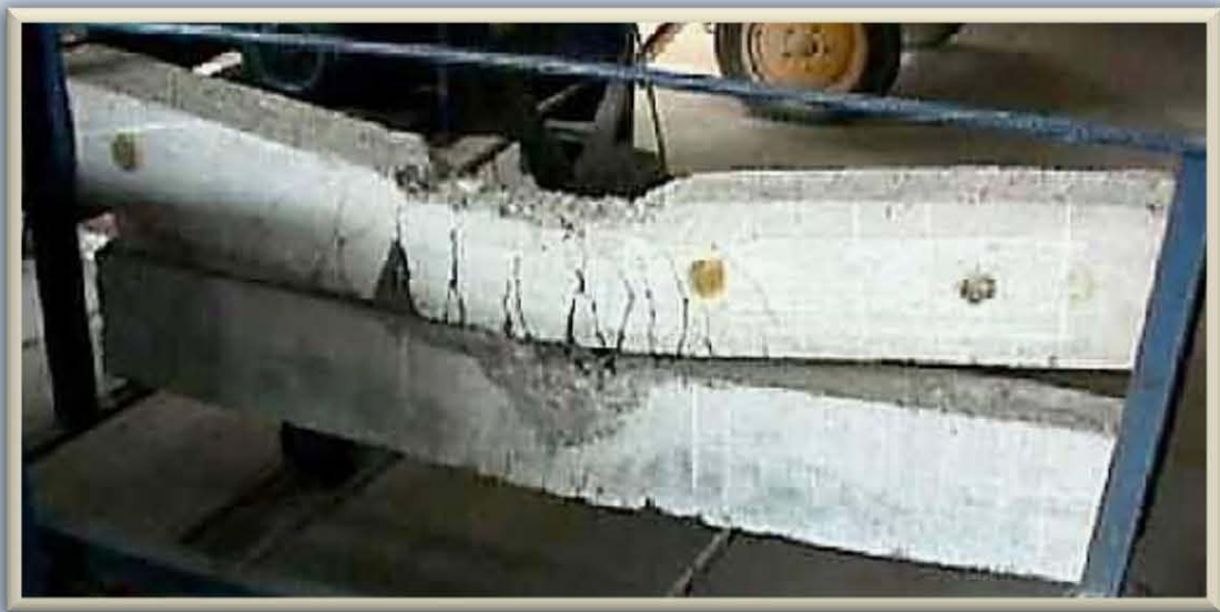
Fig. 1.2.1.b.2-1) Ensayos de falla por flexión en vigas de concreto reforzado. Formación de grietas verticales al centro del claro y aplastamiento del concreto en la zona de compresión
