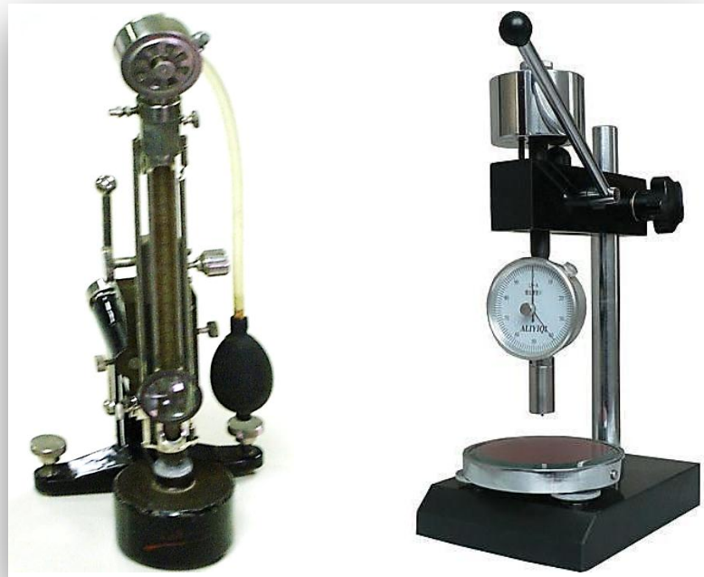
Fig.1.3.2.4. Escleroscopios Shore convencionales (analógicos). a) con tubo graduado; b) de carátula
