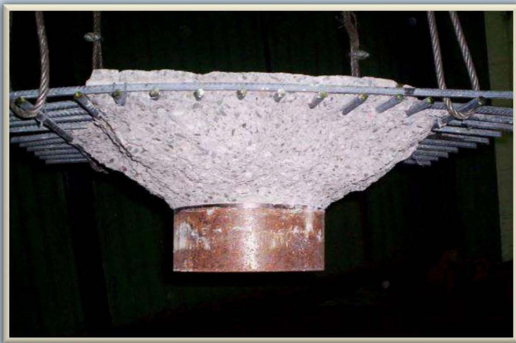
Fig. 1.2.1.d.2-1.1) Configuración de agrietamiento y falla en planta y elevación, del bloque de unión losa-columna, al concluir el ensayo. La falla es de tipo frágil por cortante
