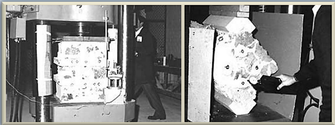
Fig. II.13. Ensayos de compresión para mampostería de muros
