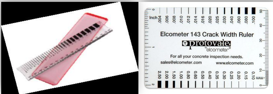
Fig. 1.1.a) Grietómetros de comparación
