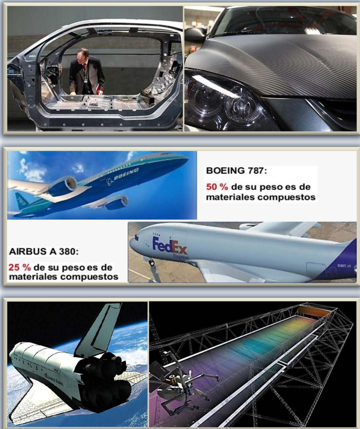
Fig. 2.3.3.1. Usos generales de los “CFRP”. Arriba, formando parte del chasis monocasco y carrocería de un automóvil común. En medio, representando un porcentaje importante del peso total de aviones comerciales. Abajo, como parte de transbordadores y perfiles estructurales de futuras estaciones espaciales
