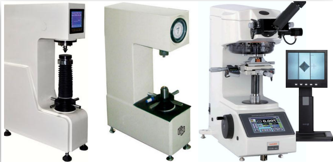
Fig. 1.3.2.3. Medidores estáticos de dureza superficial más comunes. Izq., aparato de Brinell. En medio, medidor Rockwell. Der., durómetro Vickers. Actualmente la mayoría de éstos aparatos están equipados con dispositivos electrónicos y programa de análisis, con los cuales se logran mediciones de gran precisión
