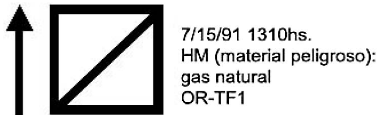
Fig. 2.1.1.5. Cuadro típico de evaluación de estructuras-nivel de riesgo establecido por "FEMA"
