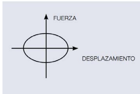
Fig. 3.1.11.b. Gráfica fuerza-deformación de disipador activado por velocidad
