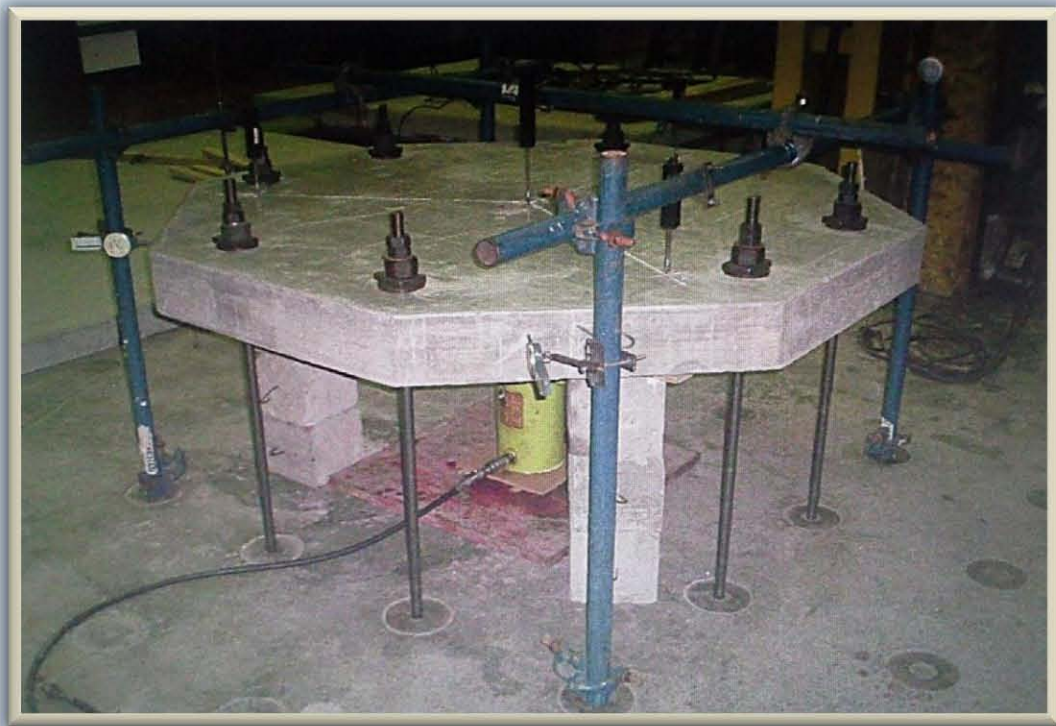
Fig. 1.2.1.d.2-1) Esquema e imagen de ensayo de falla por penetración en losa de concreto armado
