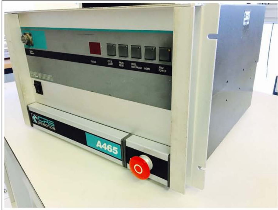
Figura 3.15: Controlador C500 del robot A465.
